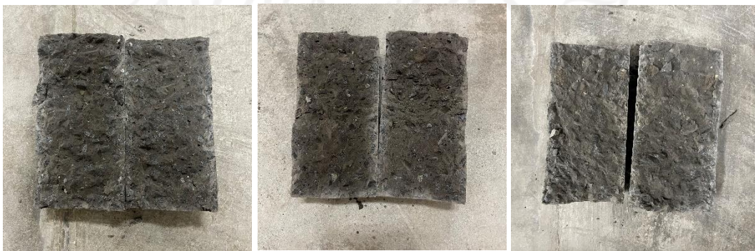
Gambar L.14.4 Pengujian Kuat Tarik Beton FS60 Umur 28 Hari
