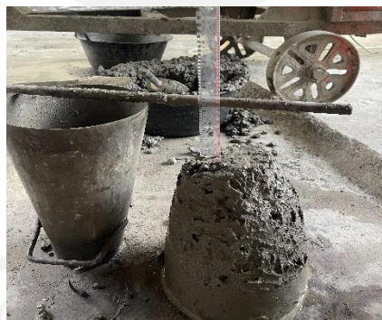
Gambar L.11.3 Proses Pengujian Slump Campuran Beton
