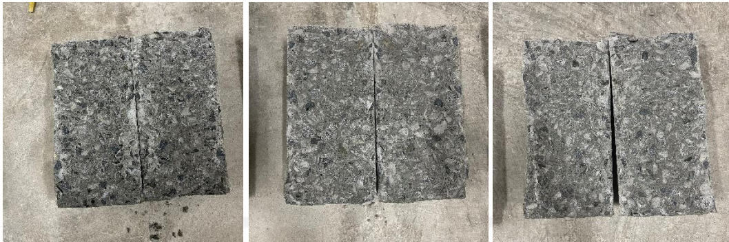
Gambar L-14.1 Pengujian Kuat Tarik Beton Normal (BN) Umur 7 Hari
