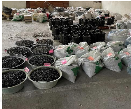
Gambar L.11.1 Proses Persiapan Cetakan dan Material Campuran Beton
