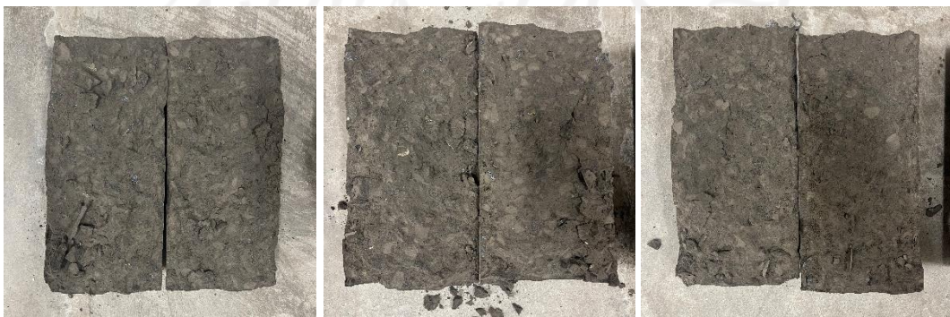
Gambar L.14.8 Pengujian Kuat Tarik Beton FS80 Umur 28 Hari
