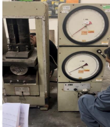
Gambar L.11.9 Proses Pengujian Kuat Tarik Benda Uji
