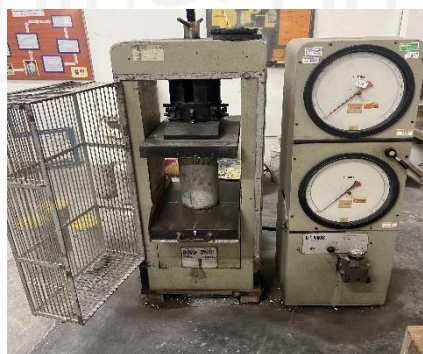
Gambar L.11.8 Proses Pengujian Kuat Tekan Benda Uji
