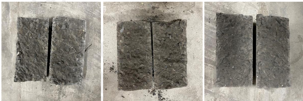
Gambar L.14.6 Pengujian Kuat Tarik Beton FS70 Umur 28 Hari
