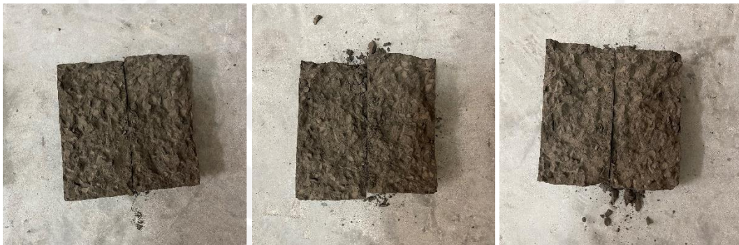
Gambar L.14.10 Pengujian Kuat Tarik Beton FS90 Umur 28 Hari
