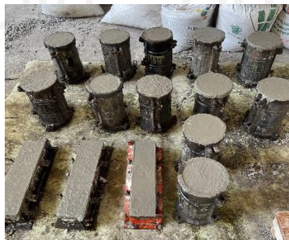
Gambar L.11.4 Beton Basah pada Cetakan Beton
