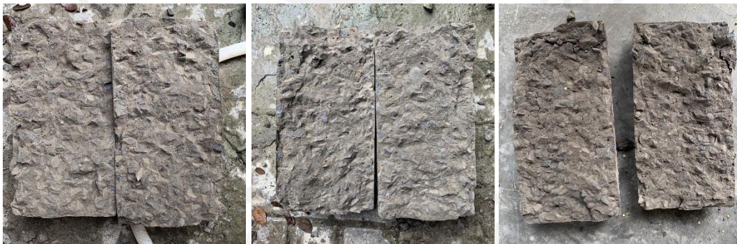
Gambar L-14.3 Pengujian Kuat Tarik Beton FS60 Umur 7 Hari
