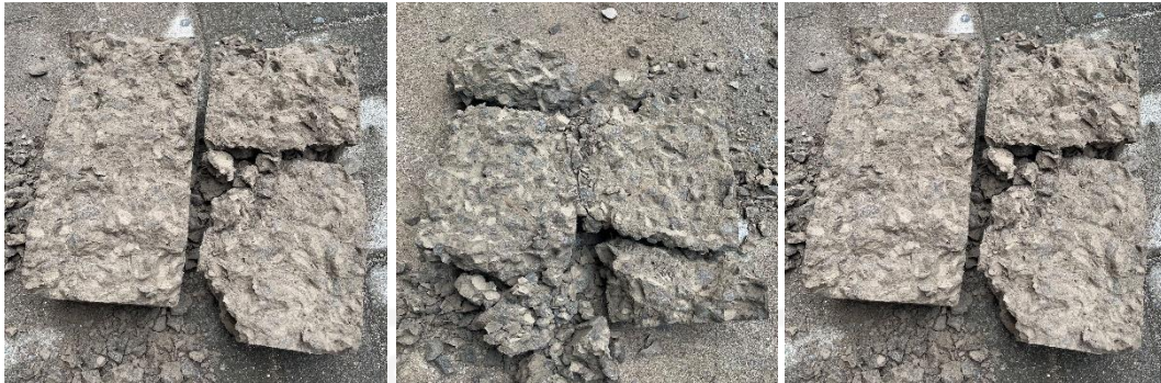
Gambar L-14.9 Pengujian Kuat Tarik Beton FS90 Umur 7 Hari
