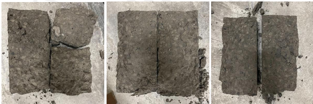
Gambar L-14.7 Pengujian Kuat Tarik Beton FS80 Umur 7 Hari
