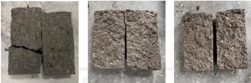
Gambar L-14.5 Pengujian Kuat Tarik Beton FS70 Umur 7 Hari
