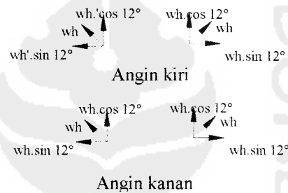
Gambar 4.5 Arah pembebanan angin
