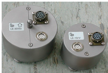
Gambar 5.1 Penunjuk Arah Mata Angin Pada Seismometer
