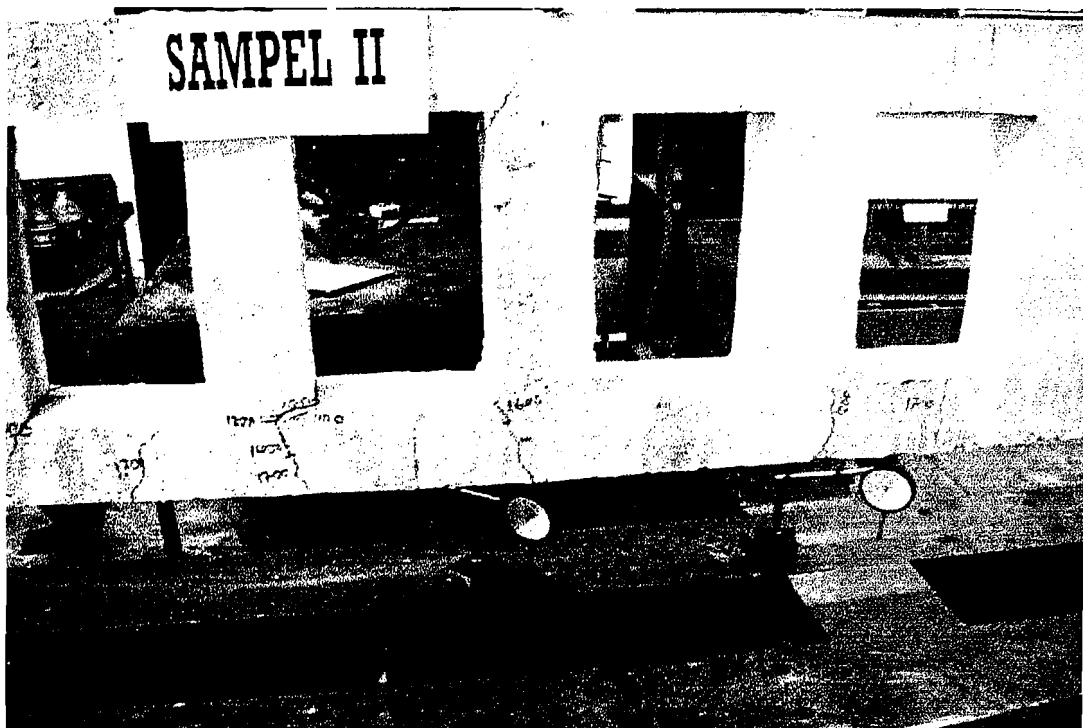
Benda uji 2 ( a/h=0,66 ) setelah dilakukan pengujian
