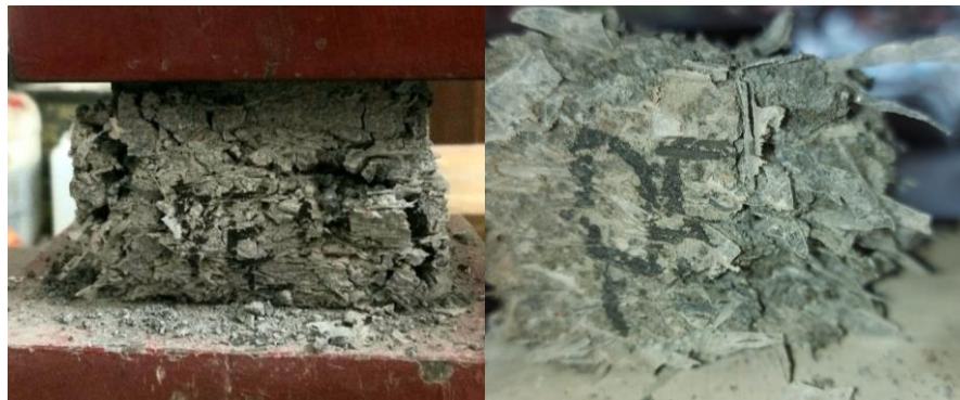
Gambar 5.12 Pola Hancurnya Paving Block Variasi 10%
