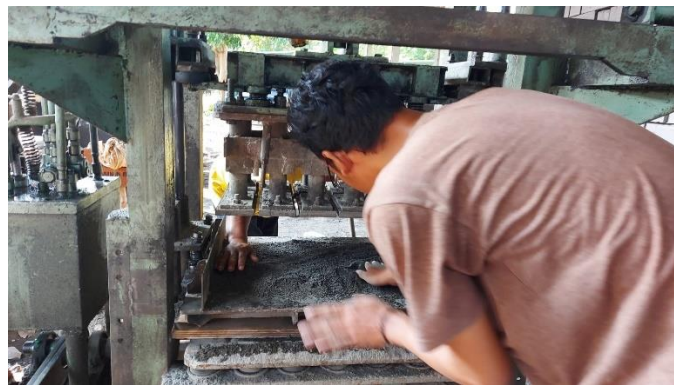
Gambar L-5.2 Proses Pencetakan Paving Block
