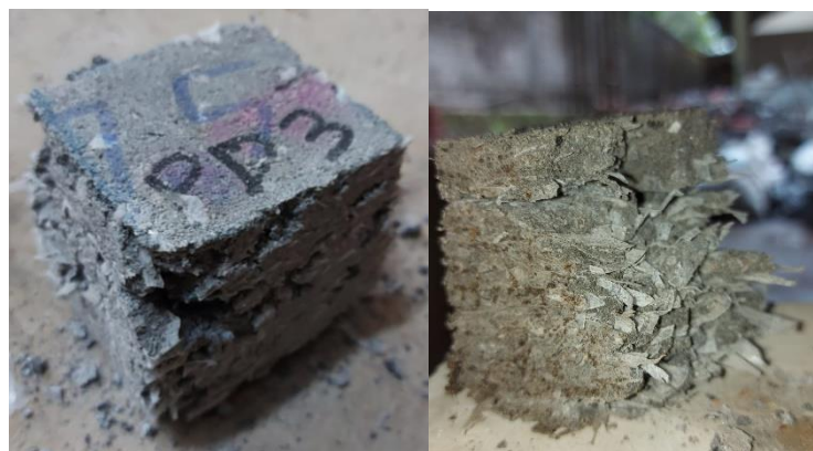
Gambar 5.11 Pola Hancurnya Paving Block Variasi 7,5%
