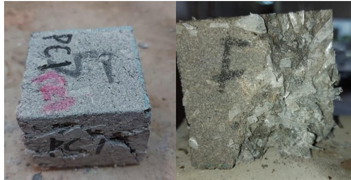
Gambar 5.10 Pola Hancurnya Paving Block Variasi 5%
