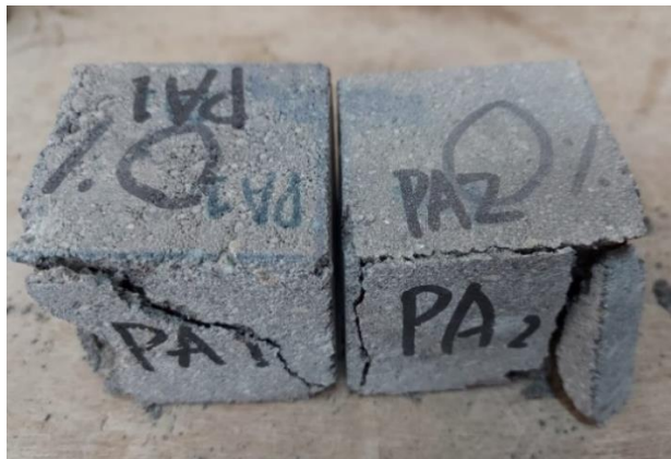
Gambar 5.8 Pola Hancurnya Paving Block Variasi 0%
