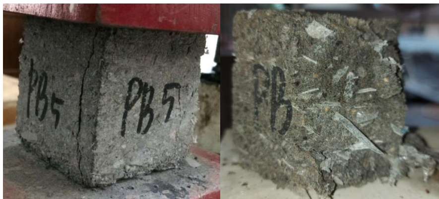
Gambar 5.9 Pola Hancurnya Paving Block Variasi 2,5%
