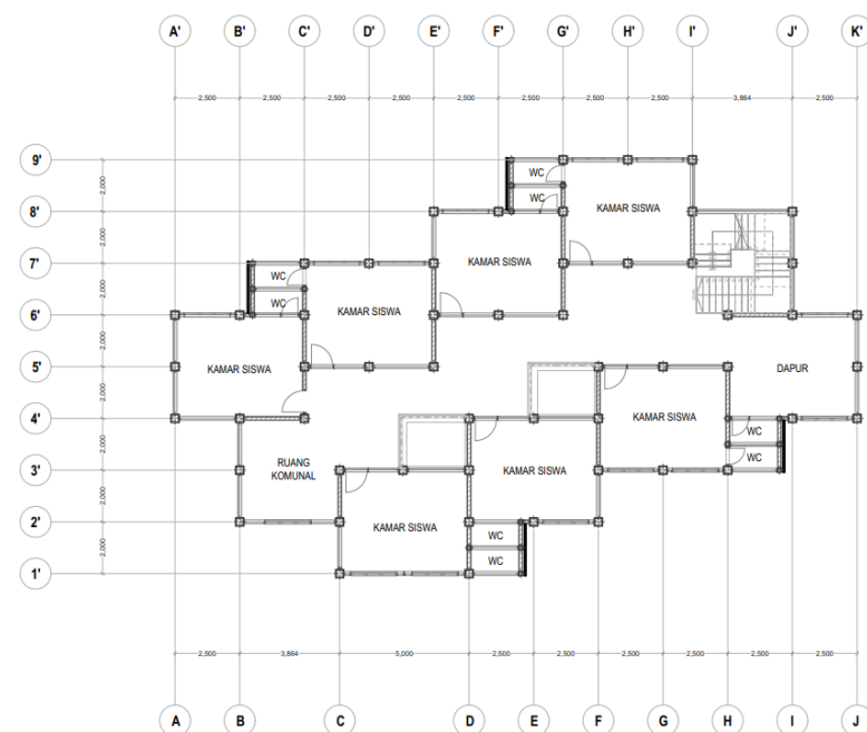
Gambar 5.11 Denah Asrama Putra Lantai 2
