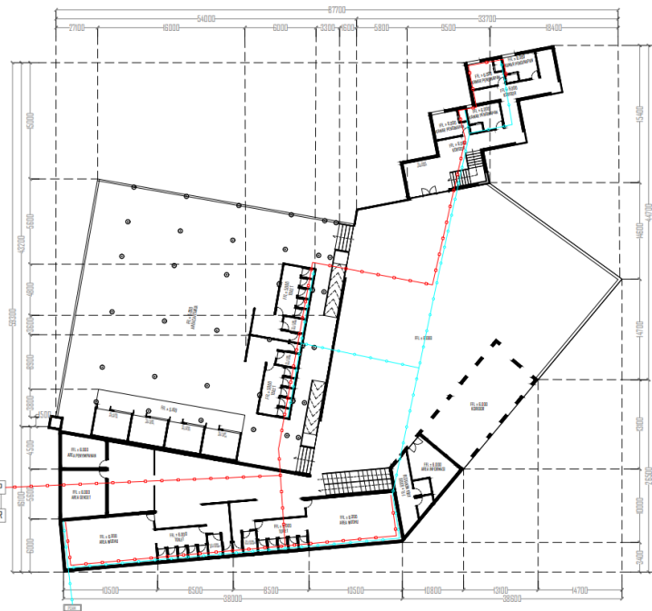
Gambar 6.5 Skema drainase sebelum perbaikan
