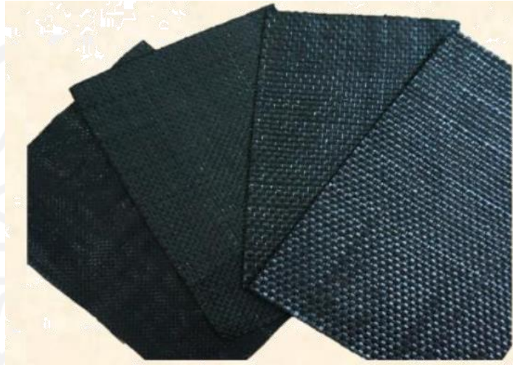
Gambar 3.8 Geotekstil Teranyam (Woven)
