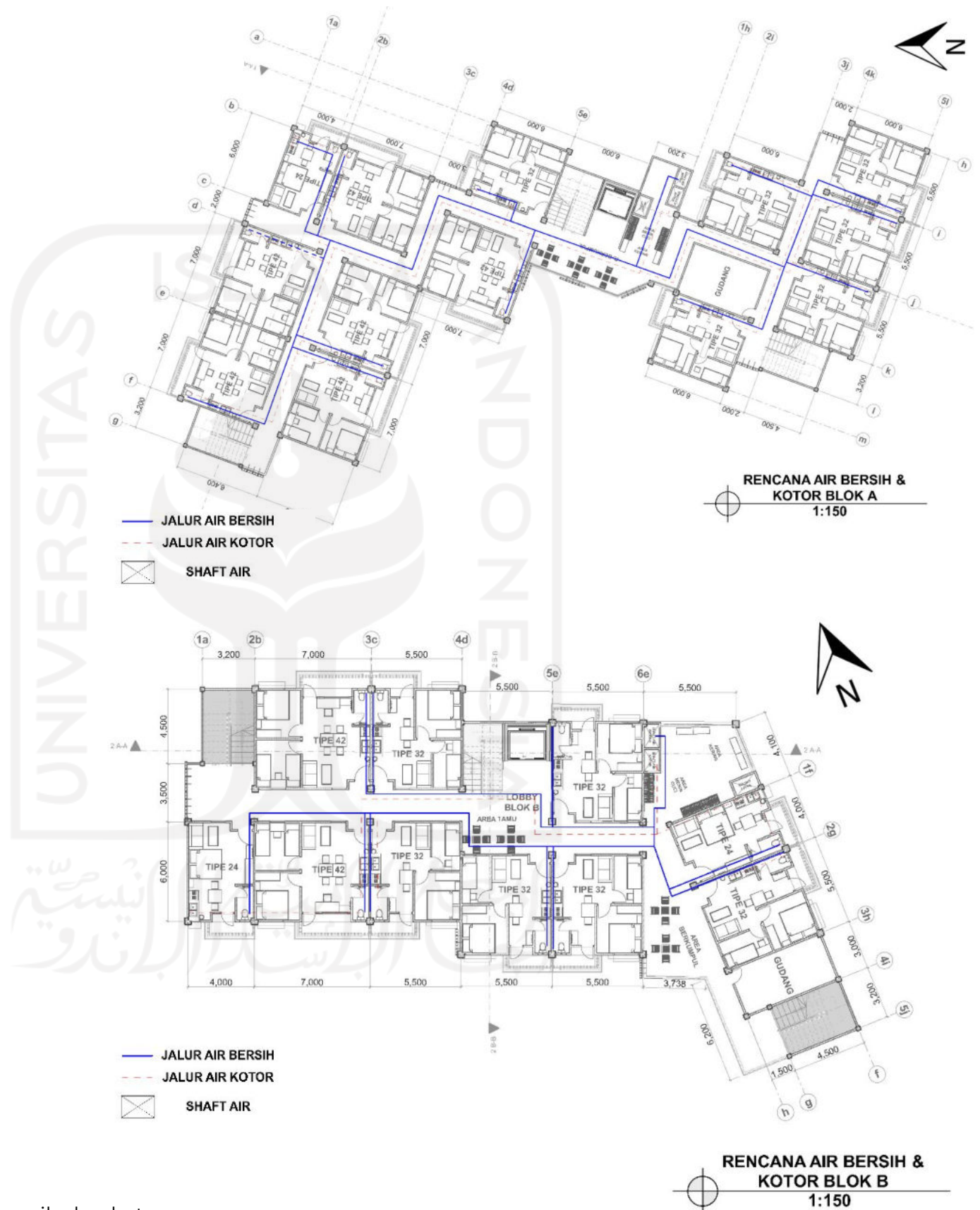
Gambar 4.23 Utilitas air bersih dan kotor Sumber: Penulis, 2022
