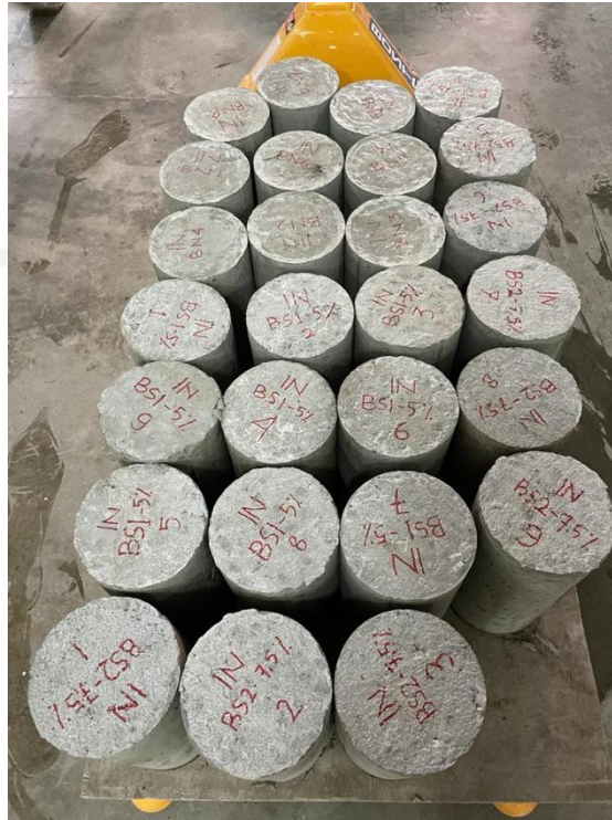
Gambar L-1.13 Beton Setelah Lepas Bekisting
