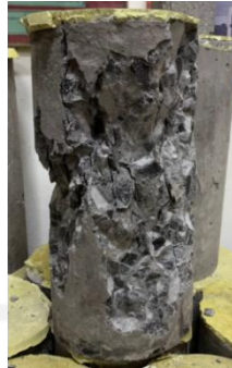
Gambar 5.8 Contoh Kerusakan Beton Akibat Uji Tekan
