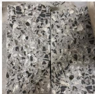
Gambar 5.12 Kerusakan Sampel Beton Akibat Uji Kuat Tarik Belah
