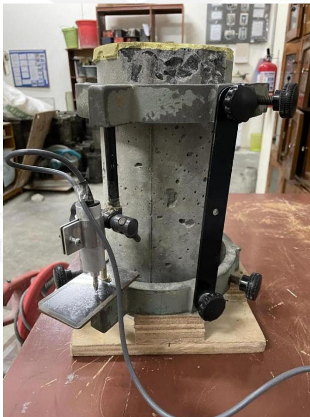
Gambar L-1.19 Kompresiometer saat Uji Modulus Elastisitas
