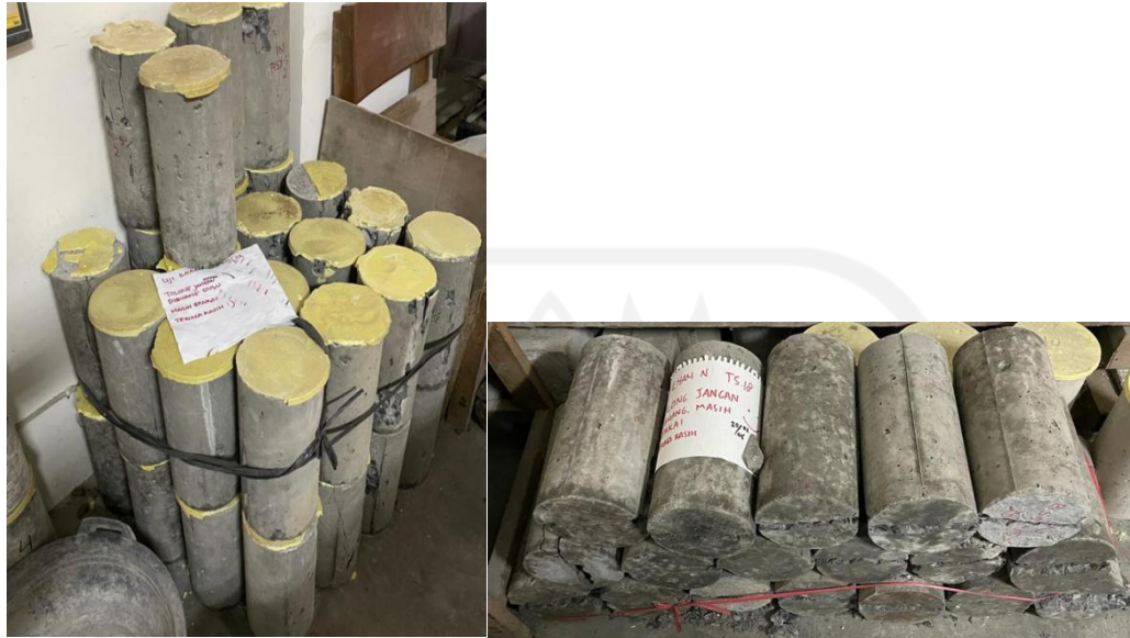
Gambar L-1.19 Beton Setelah Pengujian
