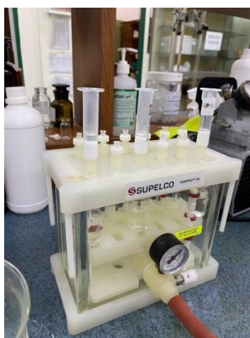
Gambar 3. 10 Proses Conditioning, Loading Sample, Vacuum Dry, Elution Pada Sampel Menggunakan Kartrid C18-E (sumber: dokumentasi pribadi, 2022)
