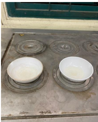
Gambar 3. 11 Proses Dryness Pada Sampel Menggunakan Waterbath (sumber: dokumentasi pribadi, 2022)
