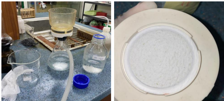
Gambar 3. 8 Proses Penyaringan Sampel Oleh Alat Vacuum Menggunakan Kertas Saring Glass Micro-Fiber 0,45 \mu\text{m} (sumber: dokumentasi pribadi, 2022)
