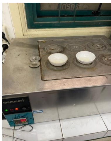
Gambar 3. 11 Proses Dryness Pada Sampel Menggunakan Waterbath (sumber: dokumentasi pribadi, 2022)
