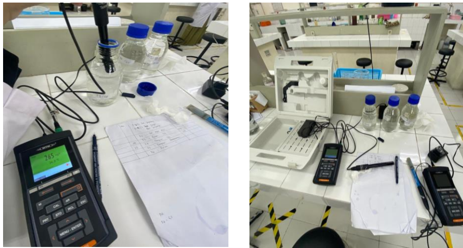
Gambar 3. 7 Pengukuran parameter TDS dan pH pada sampel air tanah (sumber: dokumentasi pribadi, 2022)
