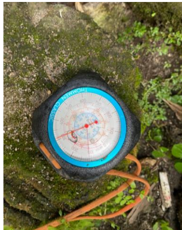
Gambar 3. 4 Pengukuran menggunakan alat water level meter dan altimeter (sumber: dokumentasi pribadi, 2022)
