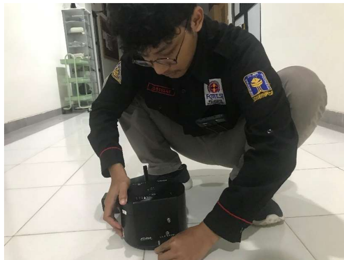
Gambar 4. 8 Pengambilan Data Mikrotremor Bangunan
