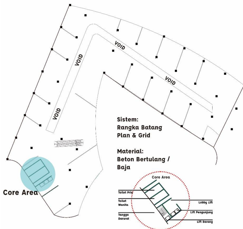
Gambar 4. 6 Skema sistem struktur pada bangunan
