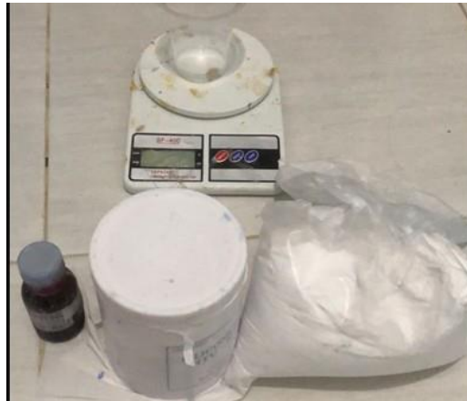
Gambar 3- 18 Timbangan digital untuk menimbang tiap bahan material
