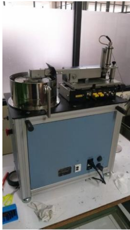
Gambar 3- 24 Alat pengujian pin on disc
