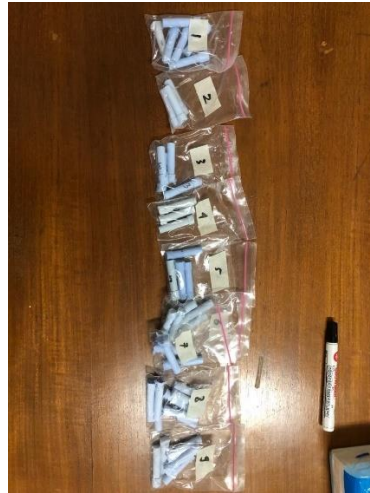
Gambar 3- 26 Spesimen uji tribologi ( pin )
