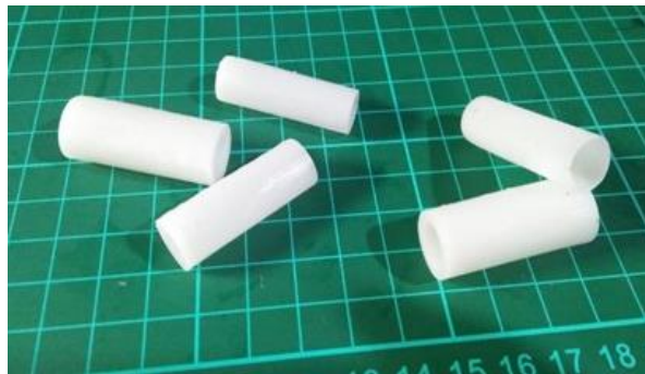
Gambar 3- 17 Cetakan spesimen dari 3d print resin
