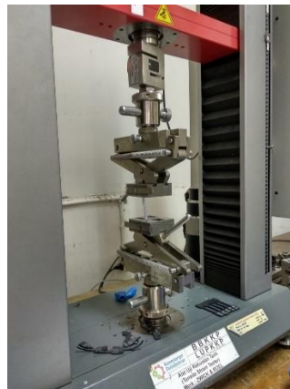
Gambar 3- 29 Proses pengujian kuat tarik
