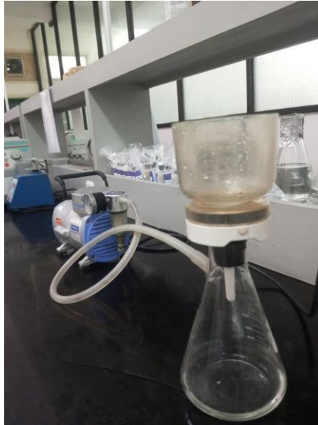
Gambar 3.9 Proses Penyaringan sampel menggunakan Pompa Vacuum
