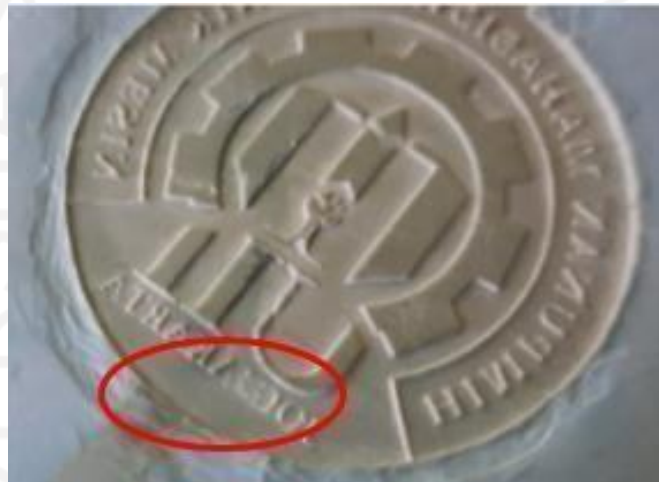
Gambar 4.69 Bagian rubber rusak
