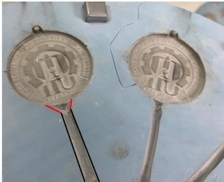
Gambar 4.56 Penyebab dimensi produk lebih besar dengan arah counter clockwise (CCW) daripada clockwise (CW)
