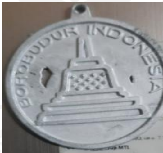
Gambar 4.68 Produk tidak terisi dengan sempurna
