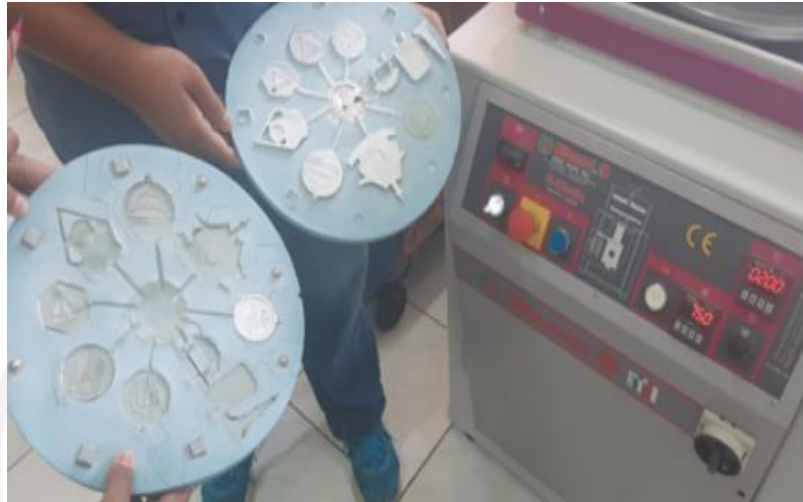
Gambar 3.25 Rubber setelah dilakukan pengecoran
