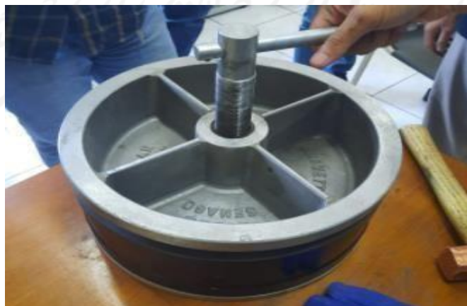
Gambar 3.21 Menutup tempat cetakan
