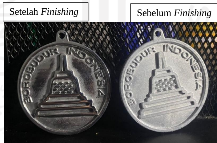
Gambar 4.64 Perbandingan sebelum dan sesudah finishing
