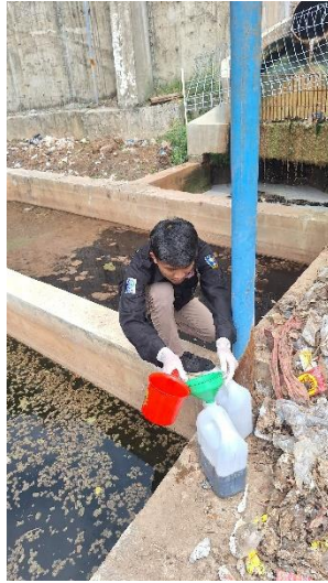
Proses pengambilan air limbah di TPA Piyungan
