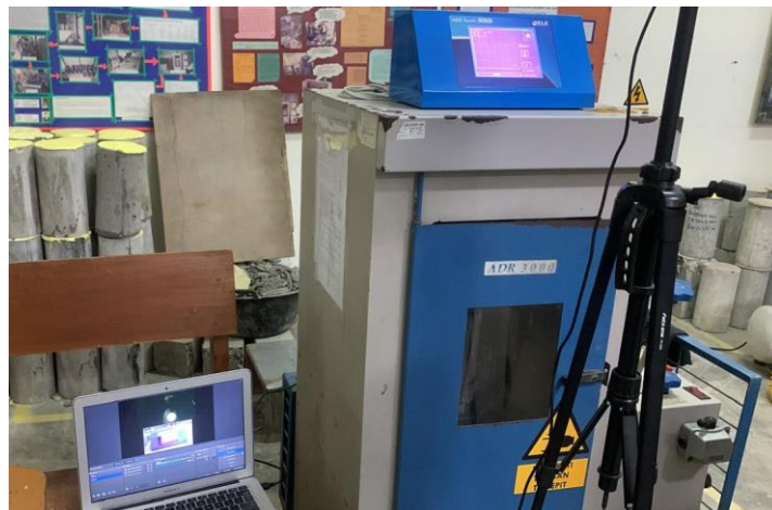
Gambar 4.10 Mesin Uji Tekan
