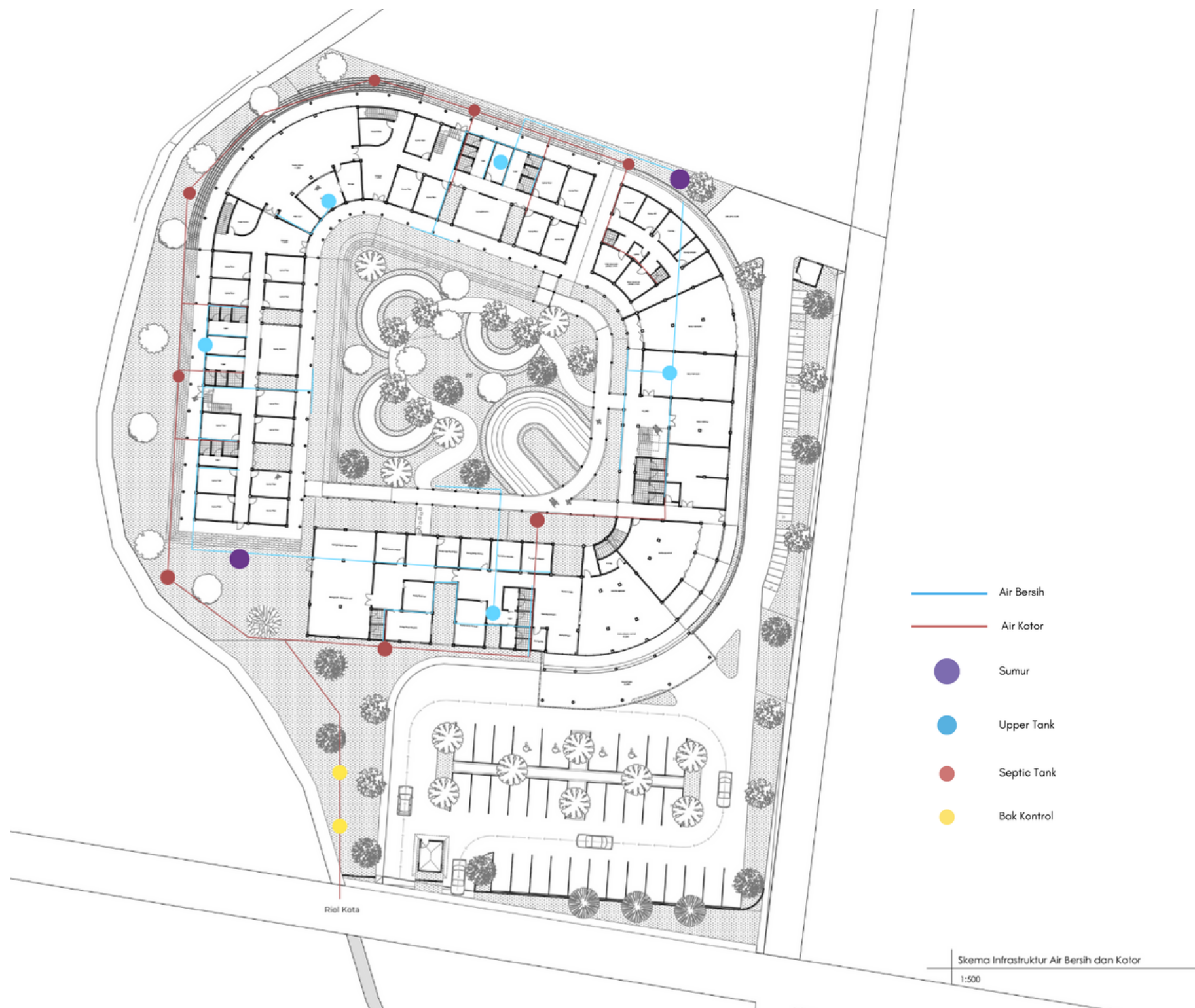
Gambar 4.20 Skema Infrastruktur Utilitas Air Bersih dan Kotor
