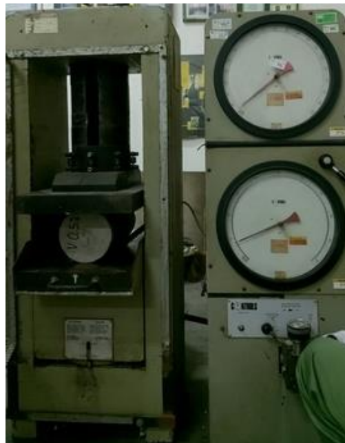
Gambar L-10.16 Pengujian Kuat Tarik Belah Beton
