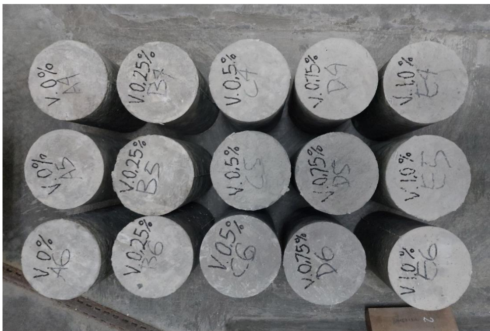
Gambar L-10.14 Benda Uji Kuat Tarik Belah Beton
