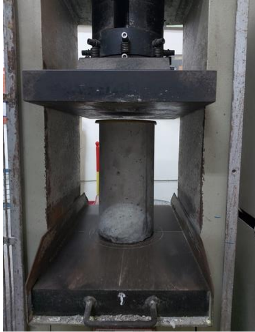
Gambar L-10.15 Pengujian Kuat Tekan Beton
