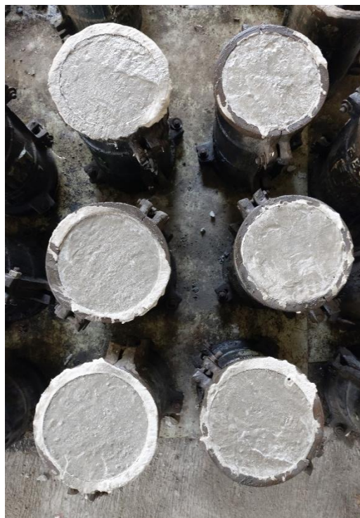
Gambar L-10.10 Benda Uji Beton Umur 1 Hari
