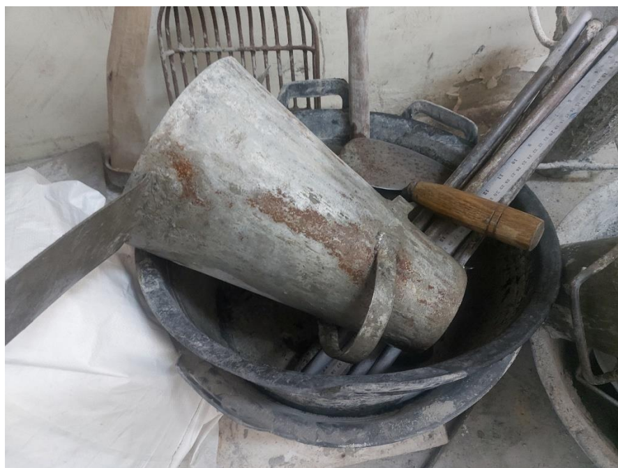
Gambar L-10.6 Peralatan Slump dan Pembuatan Campuran Beton
