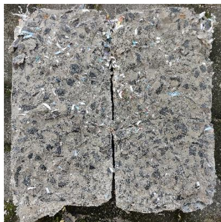
Gambar 5.14 Serat dalam Benda Uji Beton
