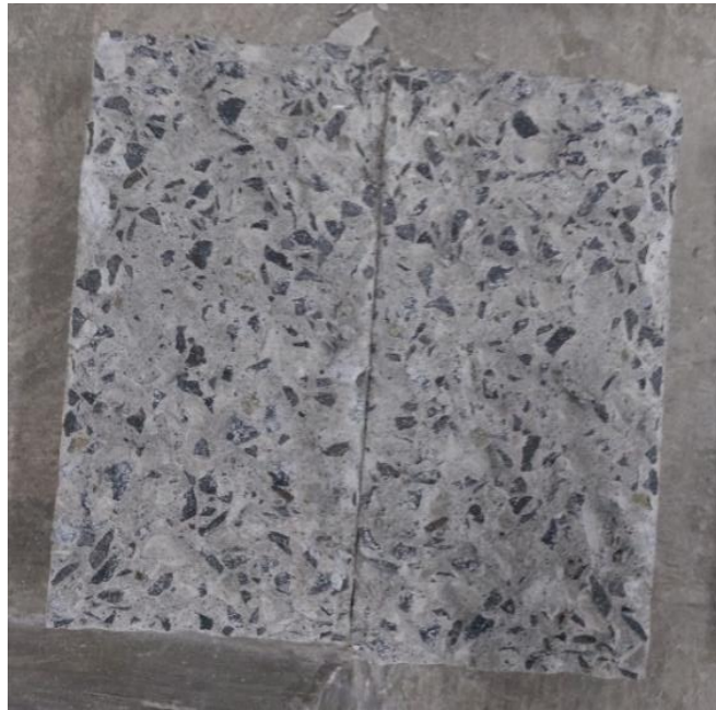
Gambar 5.15 Hasil Uji Kuat Tarik Belah Beton Normal
