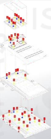
Titik Hydrant untuk keselamatan kebakaran
