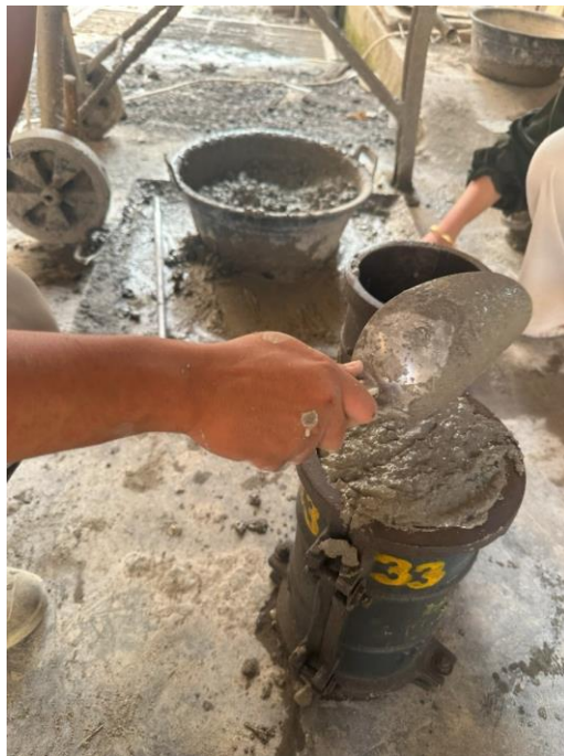
Gambar L-1. 8 Pemadatan Benda Uji Silinder
