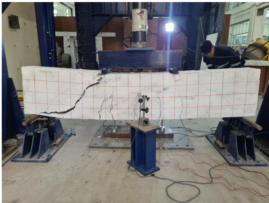
Gambar L-1. 20 Balok Coupler Setelah Pengujian
