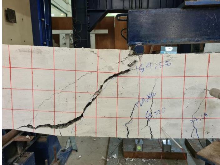
Gambar 5. 15 Keruntuhan Geser Balok Sambungan Coupler
