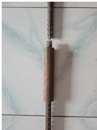
Gambar 5. 6 Baja Tulangan D16 Dengan Sambungan Coupler Setelah Pengujian
