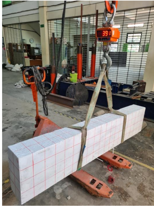
Gambar L-1. 17 Penimbangan Benda Uji Balok Coupler
