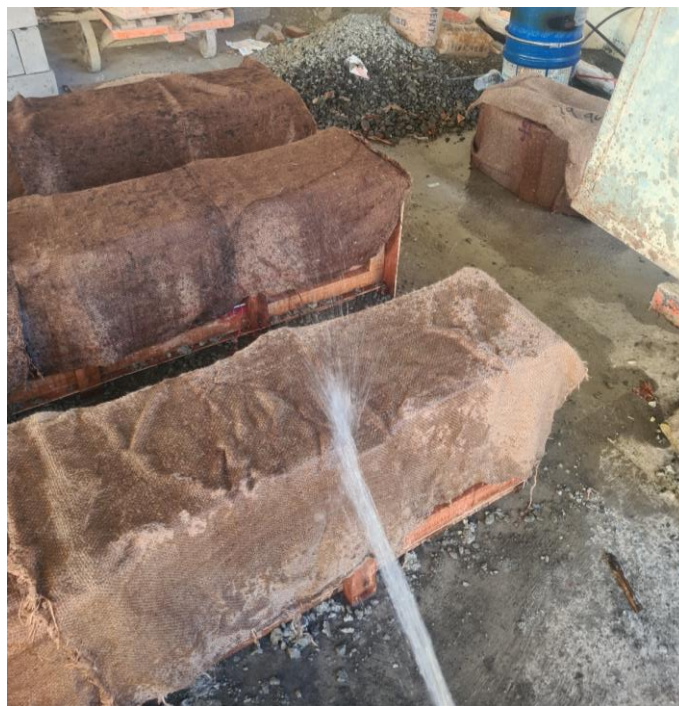
Gambar L-1. 10 Curing Benda Uji
