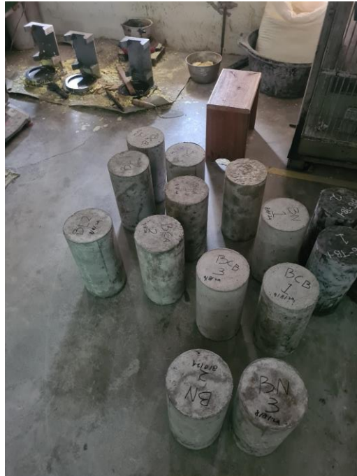
Gambar L-1. 11 Benda Uji Silinder Sebelum Pengujian
