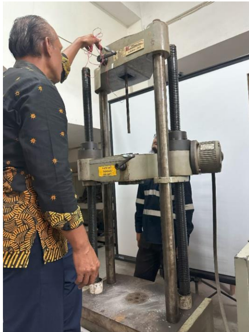
Gambar L-1. 2 Pengujian Kuat Tarik Baja Tulangan
