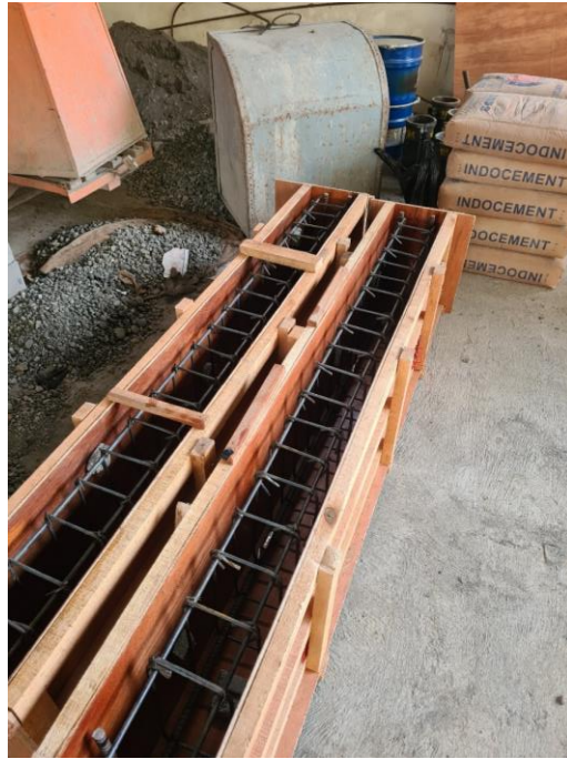
Gambar L-1. 5 Benda Uji Balok Sebelum Di Cor
