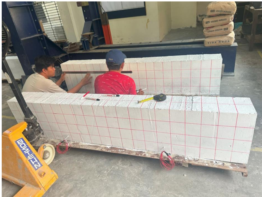
Gambar L-1. 14 Pengecatan dan Garis per 10 cm Pada Balok
