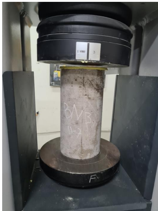
Gambar L-1. 12 Pengujian Benda Uji Silinder
