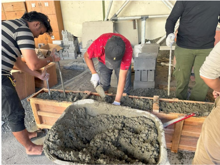
Gambar L-1. 9 Pemadatan Benda Uji Balok
