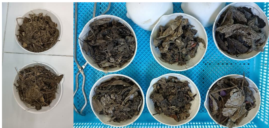
Gambar I. 6 Hasil fisik sampel sampah setelah pengujian kadar air
