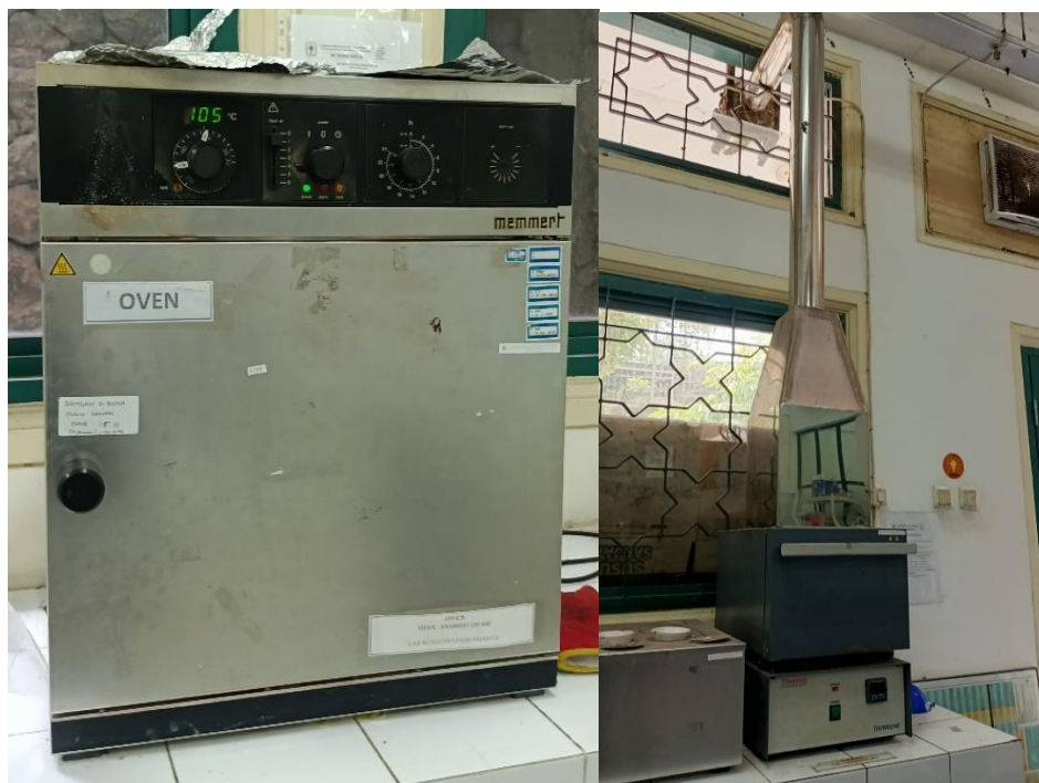
Gambar I. 4 Oven dan Furnace alat utama yang digunakan dalam pengujian
