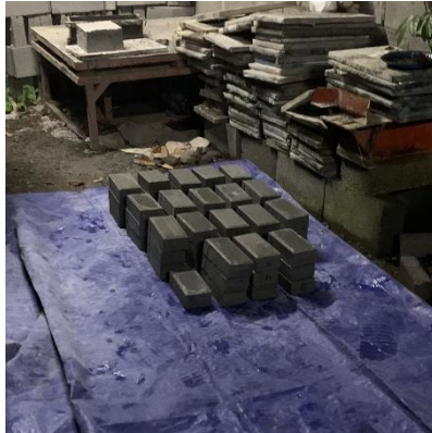
Lampiran L-4. 4 Pengeringan Paving Block Setelah Proses Perendaman
