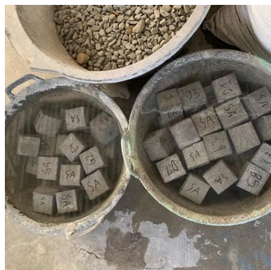
Gambar 5. 7 Proses Pengujian Daya Serap Air
