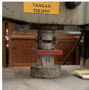
Gambar 5. 4 Proses Pengujian Kuat Tekan
