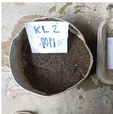
Lampiran L-3. 11 Sampel Kadar Lumpur Setelah Dicuci
