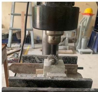
Gambar 5. 10 Proses Pengujian Keausan
