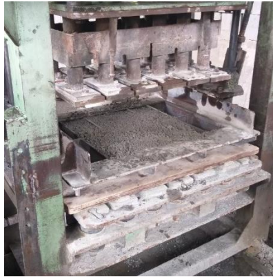
Lampiran L-4. 1 Pemadatan dan Pencetakan Paving Block
