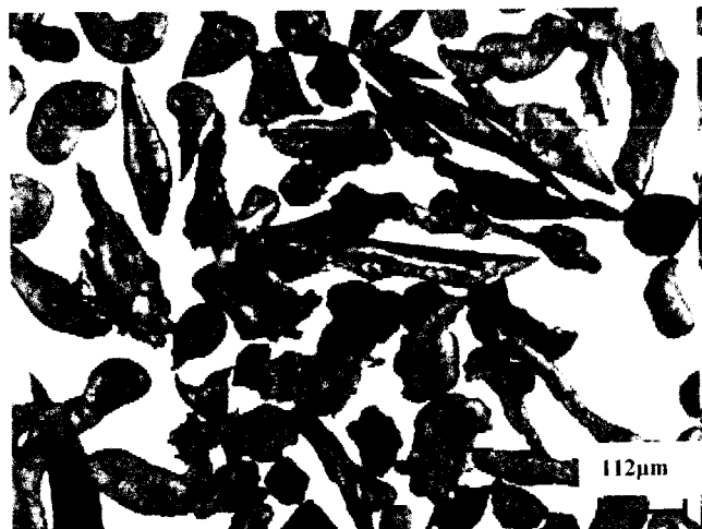
Gambar 4.3 Serbuk hasil atomisasi dilihat menggunakan mikroskop optik dengan pembesaran lensa 40 mesh < 60.
