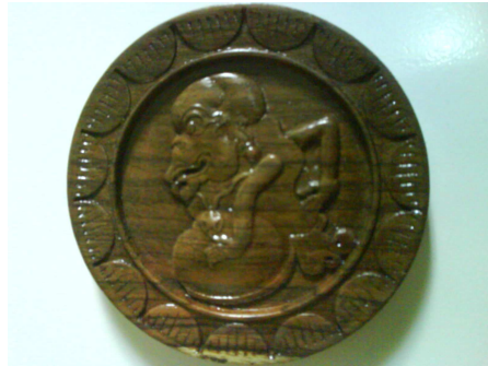
Gambar 4.14 Hasil Akhir Produk dengan Metode Pemakanan per Area.
