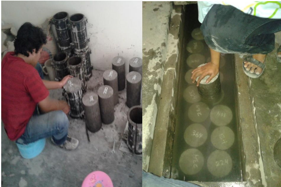
Gambar L.39 Proses Pembongkaran Cetakan Benda Uji dan Perendaman Benda Uji Setelah Berumur Satu Hari
