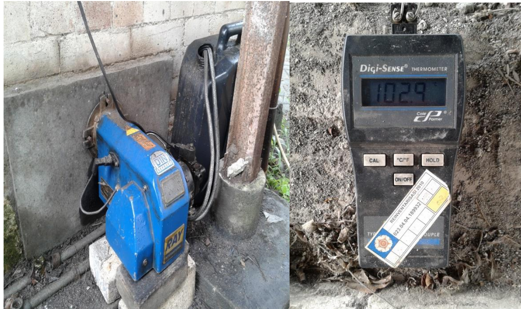
Gambar L.41 Peralatan yang Digunakan dalam Proses Pembakaran (Gambar Kiri: Burnre,Kanan : Thermometer)
