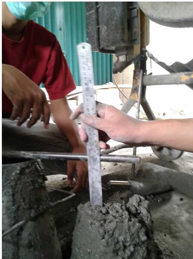
Gambar L.38 Pengukuran Slump Dan Pencetakan Benda Uji
