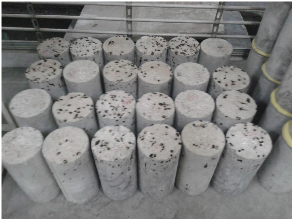
Gambar L.42 Benda Uji Setelah Diberi Pengaruh Temperatur (Dibakar)
