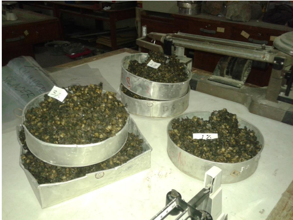
Gambar L.34 Limbah Karet yang Siap Digunakan dalam Campuran Beton
