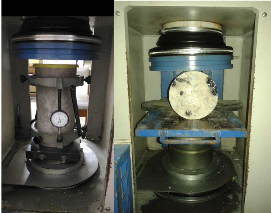
Gambar L.43 Pengujian Benda Uji (Gambar Kiri : Pengujian Kuat Desak, Kanan : Pengujian Kuat Tarik Belah)
