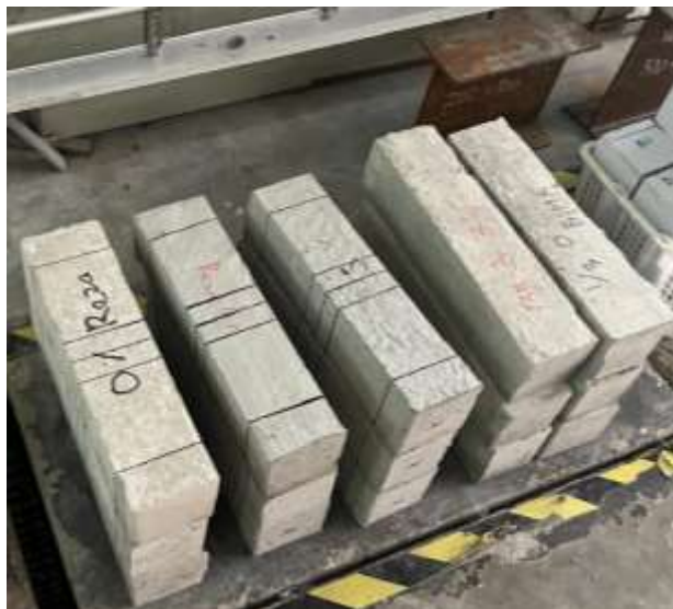
Gambar L-8. 5 Proses pemberian batas pada benda uji balok
