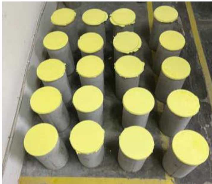
Gambar L-8. 3 Proses capping beton
