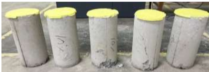
Gambar L-8. 4 Kerusakan benda uji silinder setelah pengujian
