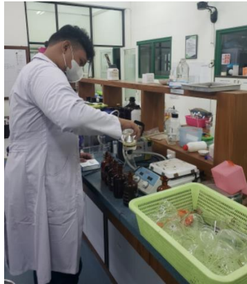
Gambar 3. 12 Proses Penyaringan Sampel Menggunakan Vacuum (Sumber: Dokumentasi Pribadi)
