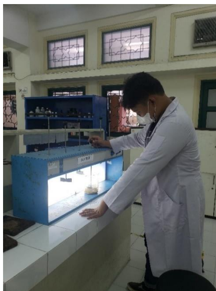
Gambar 3. 10 Proses Penambahan Larutan NaCl menggunakan Jar Test
