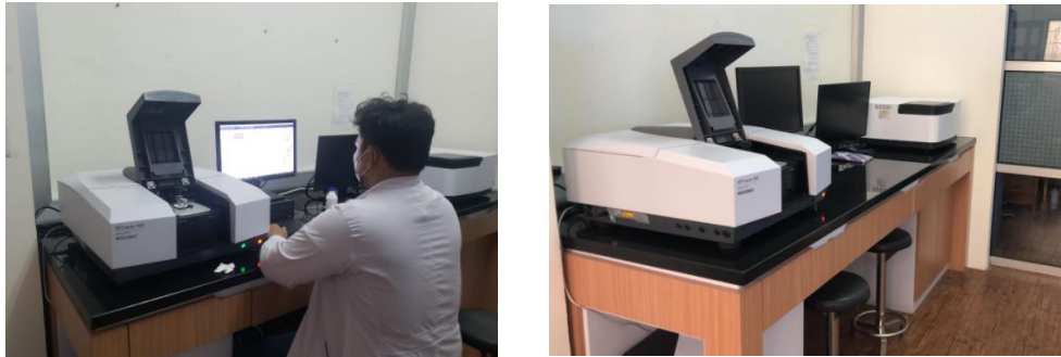
Gambar 3. 15 Proses Pengamatan Sampel Mikroplastik Menggunakan FTIR (Sumber: Dokumentasi Pribadi)
