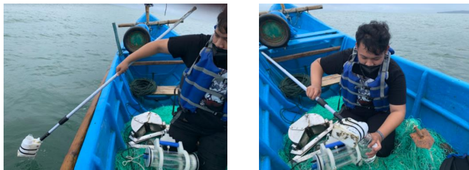
Gambar 3. 4 Proses Pengambilan Sampel Air Laut menggunakan Water Sampler (Sumber: Dokumentasi Pribadi)
