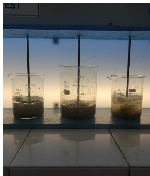
Gambar 3. 10 Proses Penambahan Larutan NaCl menggunakan Jar Test
