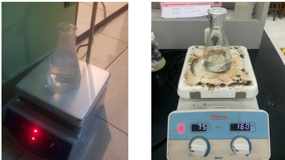
Gambar 3. 11 Proses WPO pada Sampel dengan Magnetic Stirrer (Sumber: Dokumentasi Pribadi)
