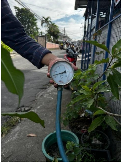
Pengukuran Tekanan Air
