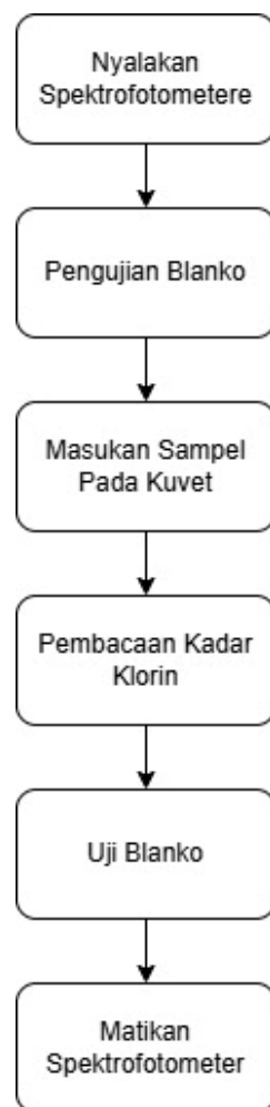
Gambar 3. 5 Diagram Alir Pengukuran Klorin
