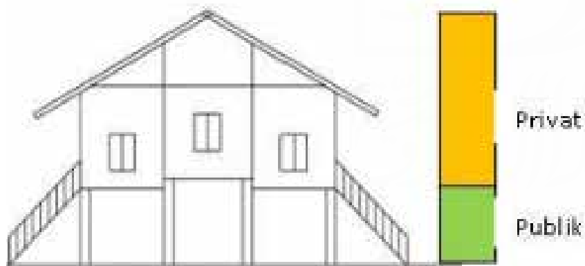
Gambar 2.3.4. Denah Rumoh Aceh dan hirarki ruang secara vertikal Sumber: Rahil Muhammad Hasbi ,(2017)
