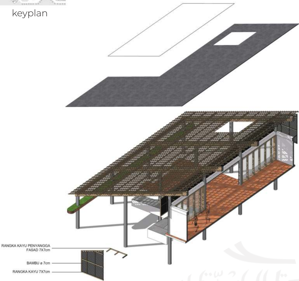
Gambar 4.38 Detail Selubung Bangunan Sumber : Penulis
