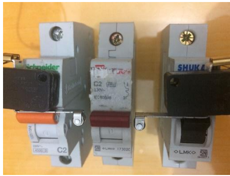
Gambar 3.5 MCB 2A merk Schneider, Broco dan Shukaku.
