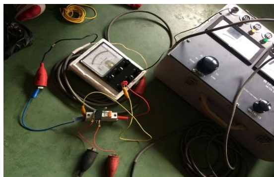
Gambar 3.8 Pengujian MCB dengan menggunakan Portable Relay Tester .
