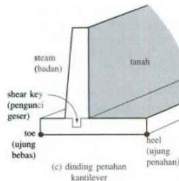
Gambar 3. 10 Dinding Penahan Tanah pada Jenis Kantilever
