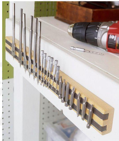
Gambar 5. 16 Referensi Penggunaan Magnetic Strip sebagai Tempat Penyimpanan Sementara
