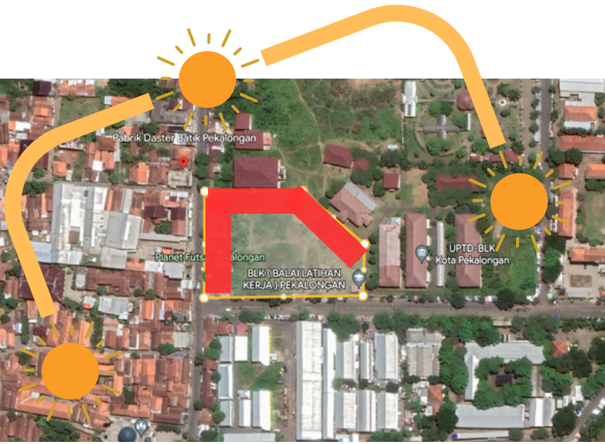
Gambar 3.2 orientasi bangunan (Sumber : penulis, 2024)
