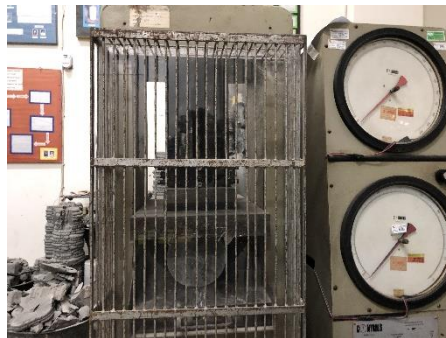
Gambar 4.4 Pengujian Kuat Tarik Belah Beton
