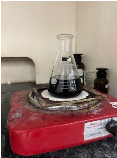
Proses Destruksi Sampel
