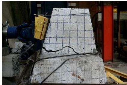
Gambar 5.7 Sampel Uji Geser pada beban Maksimum
