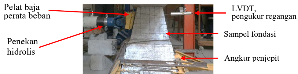
Gambar 4.8 Mesin Uji Kuat Geser
