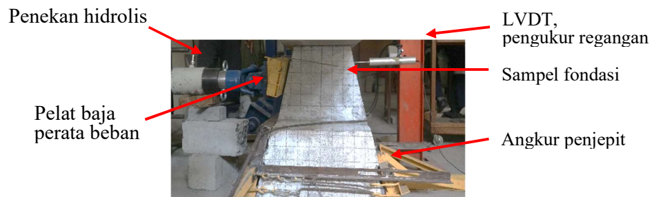
Gambar 5.6 Pengujian Kuat Geser
