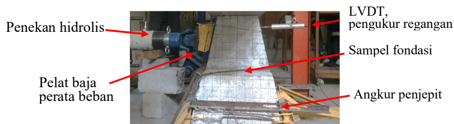
Gambar 4.33 Uji Geser Fondasi Blok Beton
