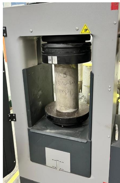
Gambar 5.13 Contoh Pengujian Kuat Tekan Beton
