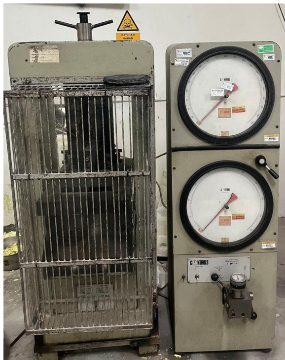
Gambar L-10.13 Proses Pengujian Kuat Tarik Belah Beton
