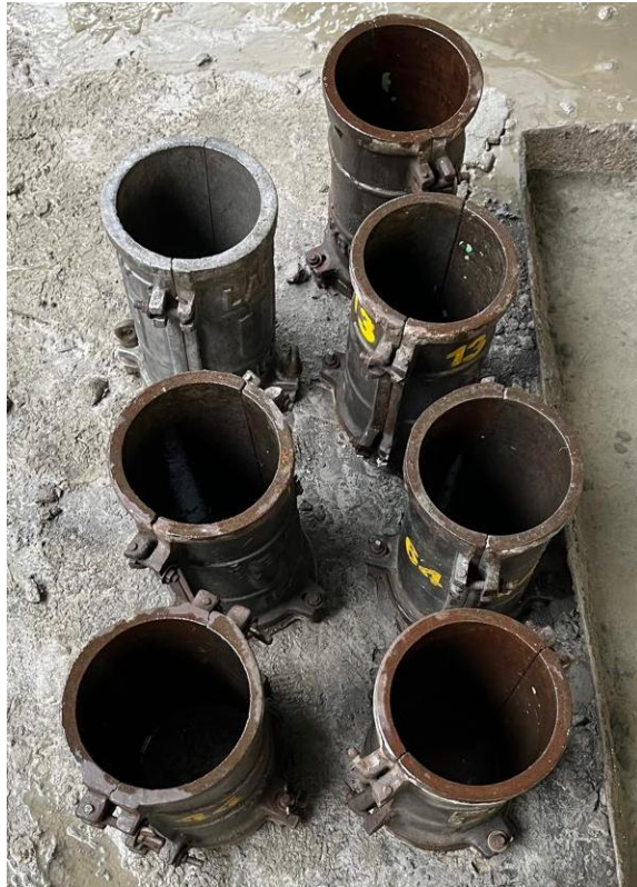
Gambar L-10.3 Persiapan Cetakan Silinder Beton
