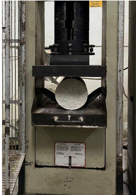
Gambar 5.16 Contoh Pengujian Kuat Tarik Belah Beton
