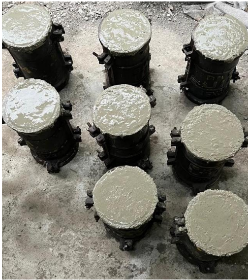
Gambar L-10.7 Proses penuangan campuran beton ke dalam cetakan dan hasilnya setelah 24 Jam
