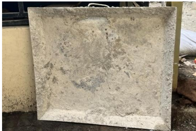
Gambar L-9.18 Pelat adukan beton
