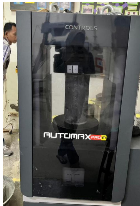
Gambar L-10. 11 Proses Pengujian Kuat Tekan Beton
