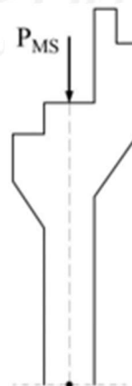
Gambar 5.60 Reaksi Berat Sendiri Struktur Atas pada Breast Wall
