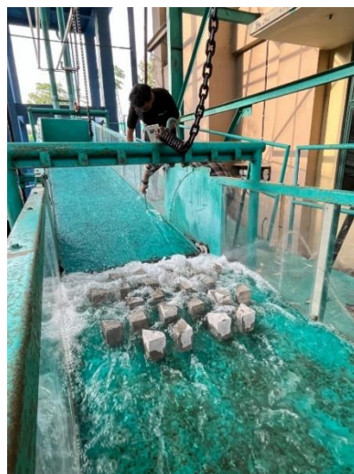
Gambar 5. 5 Kondisi Aliran Variasi 1 Baffle blocks Buka 3 (sumber: dokumentasi pribadi)
