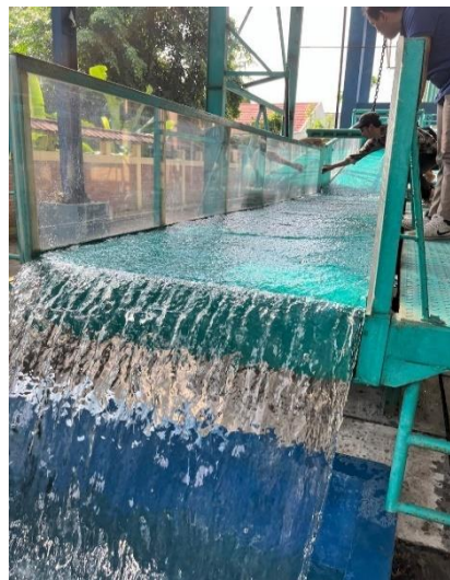
Gambar 5. 3 Kondisi Aliran tanpa Baffle blocks Bukaannya 3 (sumber: dokumentasi pribadi)
