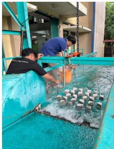
Gambar 5. 4 Kondisi Aliran Variasi 1 Baffle blocks Buka 2 (sumber: dokumentasi pribadi)
