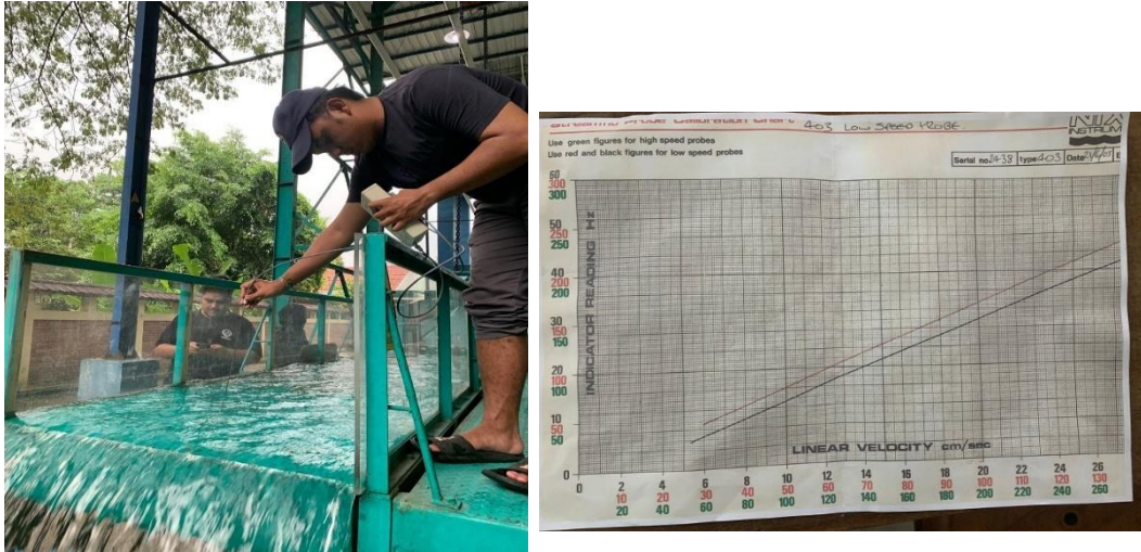
Gambar 5. 7 Pengukuran kecepatan dengan current meter dan Grafik Velocity
