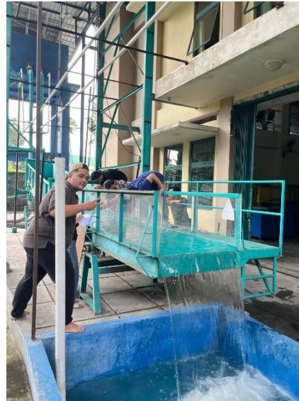
Gambar 5. 2 Kondisi Aliran tanpa Baffle blocks Bukaannya 2 (sumber: dokumentasi pribadi)
