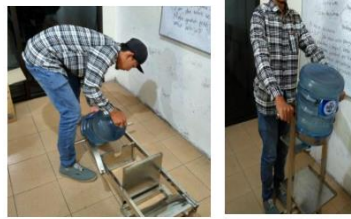
Gambar 2. 11 Mekanisme Alat pengangkat Galon oleh Suparti dan Ria (2017)
