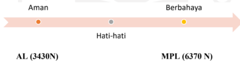
Gambar 2. 13 Batasan Angkat dalam Biomekanika Menurut NIOSH
