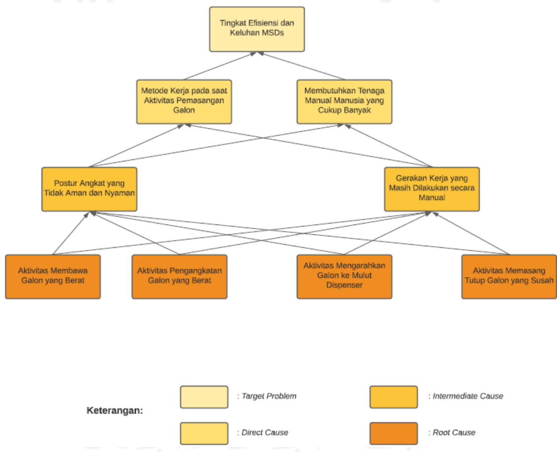
Gambar 4. 2 Cause and Effect Chain Analysis untuk TRIZ
