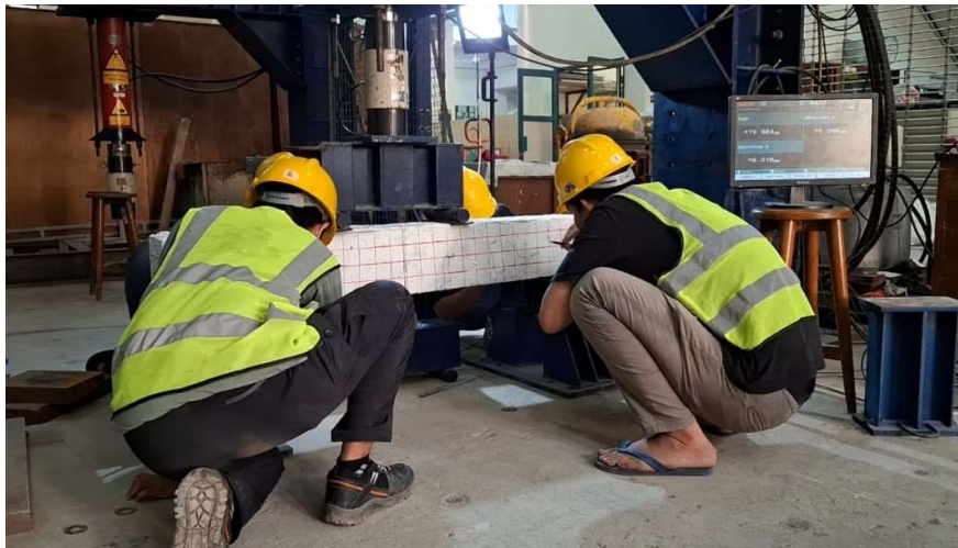
Gambar 14 Pengujian Lentur Sampel Balok kontrol
