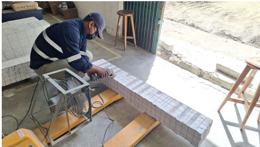
Gambar 16 Gerinda Balok Sampel perkuatan sebelum penempelan Fiber
