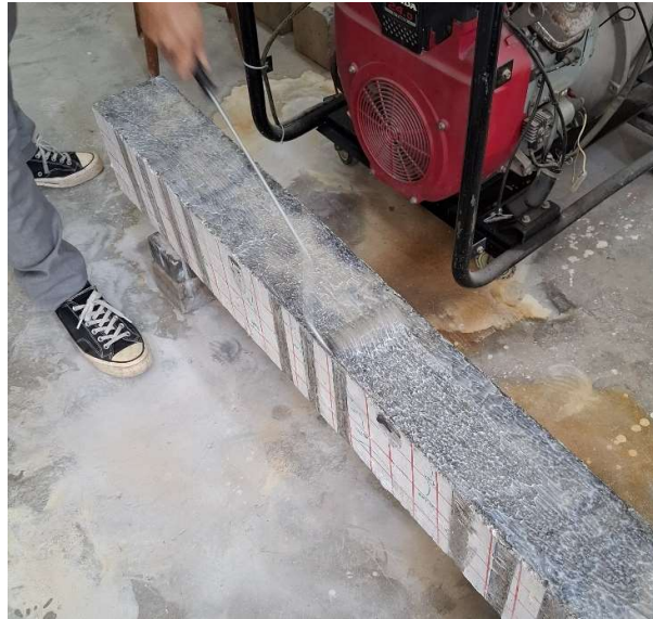
Gambar 4. 4 Pelapisan epoksi ke permukaan balok
