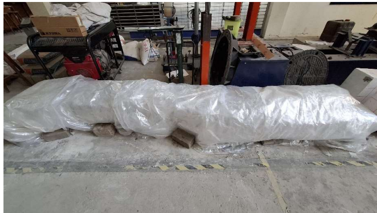
Gambar 4. 6 Penutupan balok dengan plastik agar terhindar dari debu
