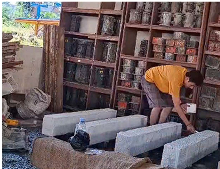
Gambar 10 Pengecatan Sampel Balok
