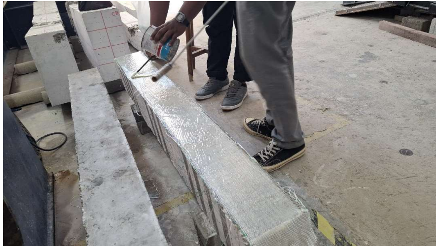
Gambar 17 Penempelan Fiber ke sampel balok perkuatan setelah di beri beban 50% dan 75% dari beban maksimum balok kontrol
