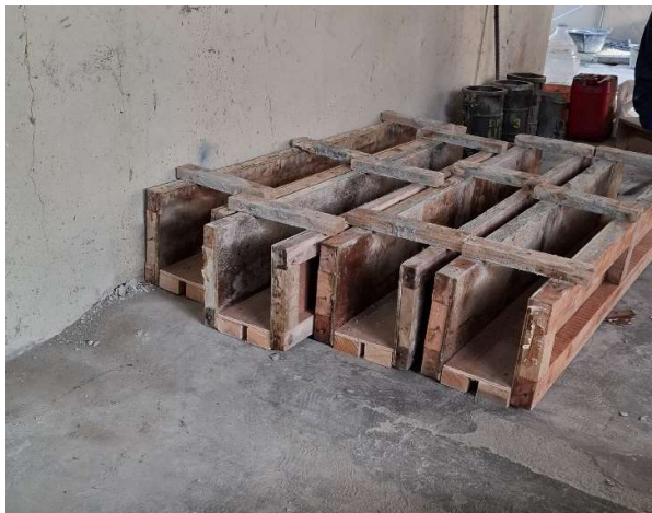
Gambar 6 Pembuatan Bekisting Untuk Sampel Balok Pengujian
