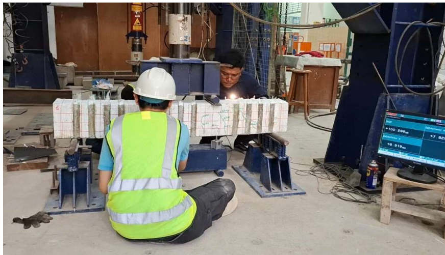
Gambar 18 Pengujian sampel Balok perkuatan setelah diberi GFRP
