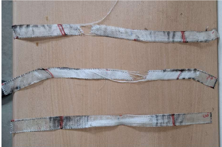
Gambar 13 Sampel GFRP setelah dilakukan uji tarik GFRP
