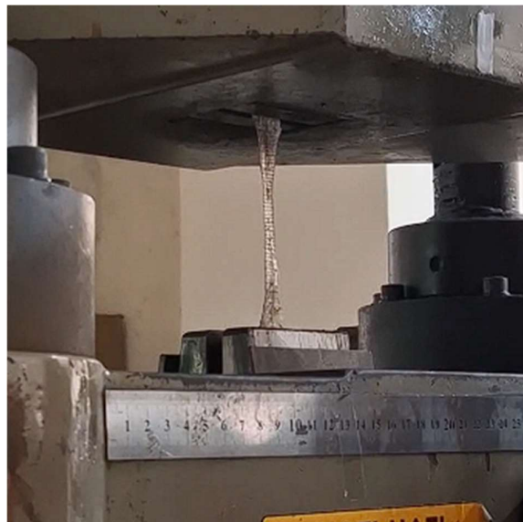
Gambar 12 Uji tarik GFRP menggunakan alat CTM
