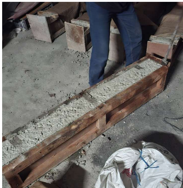
Gambar 8 Pembukaan Bekisting sampel balok Setelah 28 Hari
