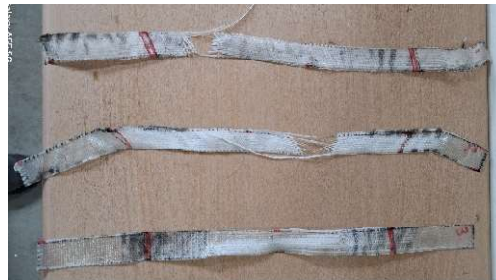
Gambar 5. 7 Sampel GFRP setelah Pengujian Kuat Tarik
