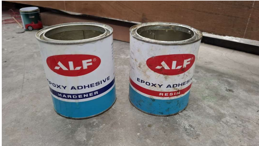
Gambar 15 Epoksi untuk merekatkan Fiber ke Sampel Balok
