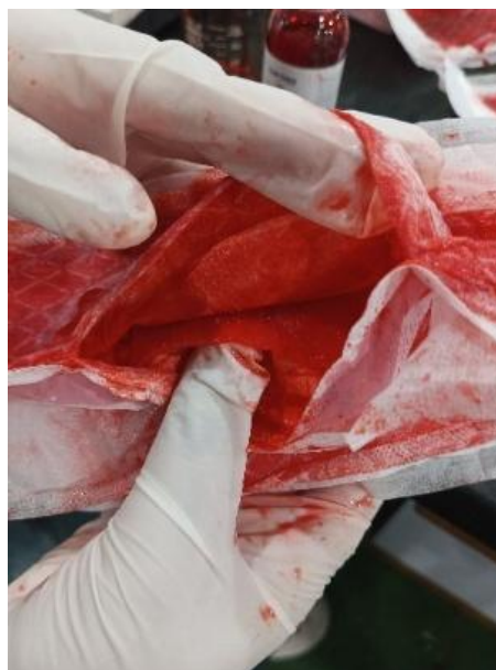
Gambar 3. 60 Kenampakan Bio-Film setelah penyerapan cairan
