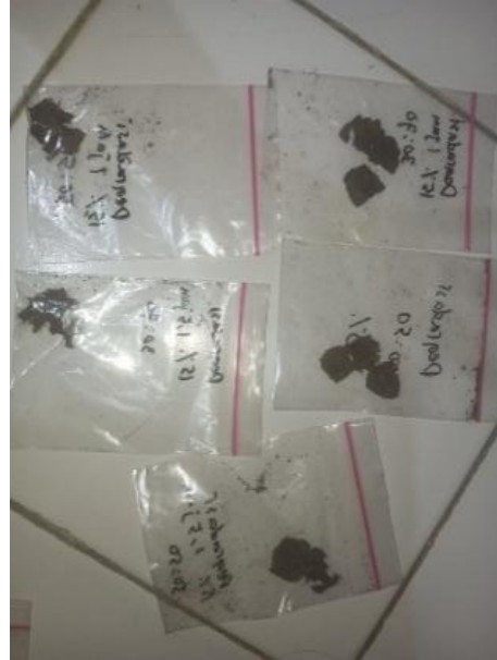
Gambar 4. 12 Sampel Bio-Film setelah terdegradasi
