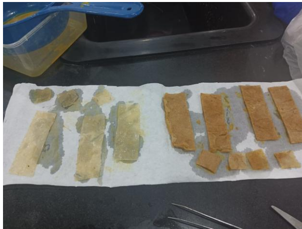
Gambar 3. 58 Sampel Bio-film Hasil Finishing Antibakteri Ekstrak Kulit Manggis
