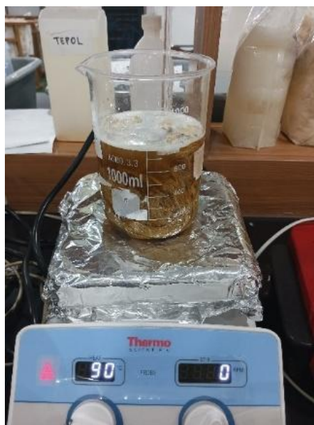
Gambar 3. 49 Proses Preparasi Serap Pelepah Pisang
