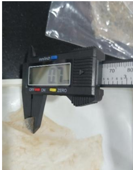
Gambar 3. 55 Proses Uji Ketebalan Fisik Bio-Film Absorbent
