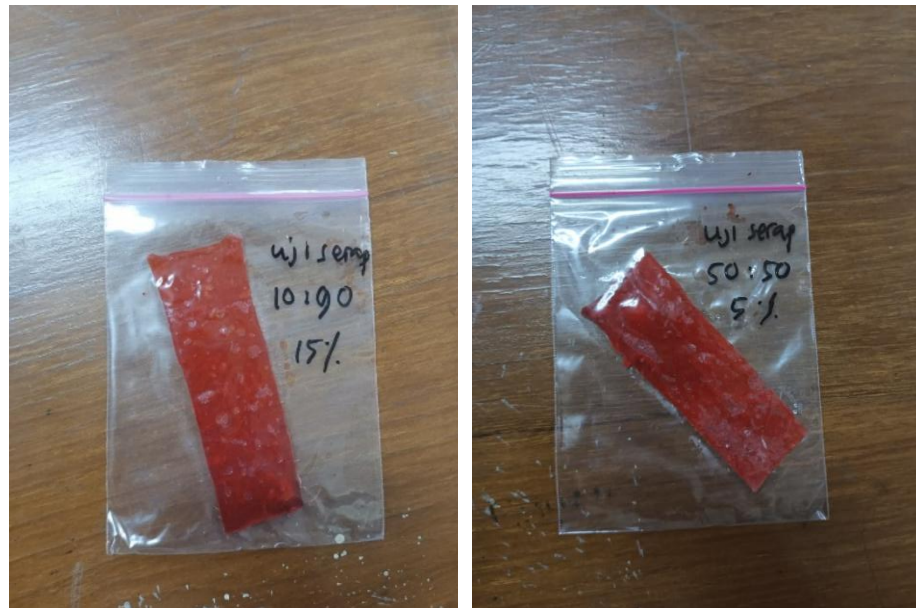
Gambar 4. 10 Sampel Bio-film Hasil Uji Daya Serap
