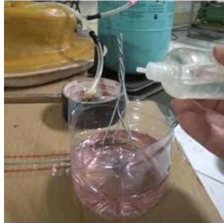
Gambar 3.45 Pencampuran Resin dan Katalis
