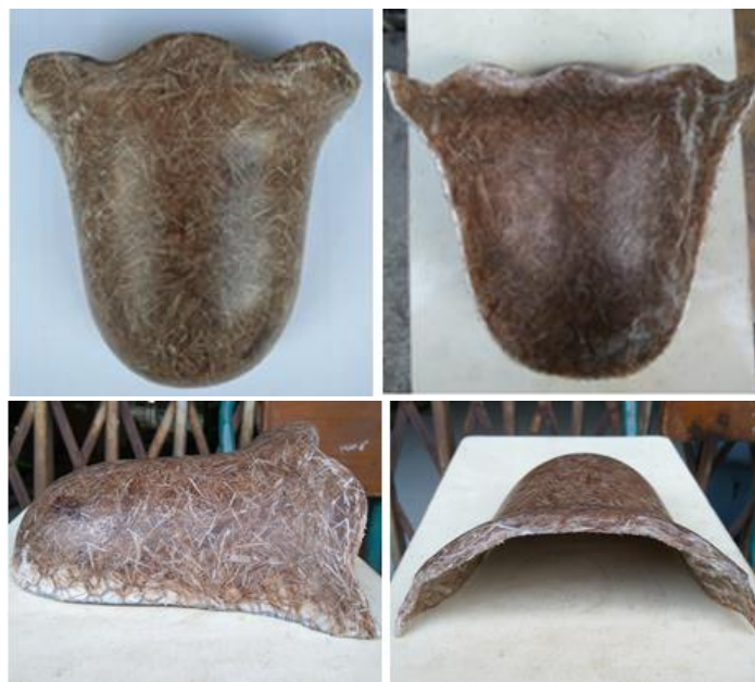
Gambar 4.10 Komposit Sandwich dengan Penggunaan 50% Serat Bulu Ayam
