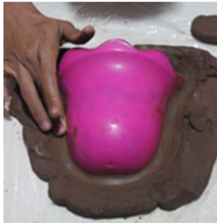
Gambar 3.19 Pemberian Support Pada Master Cetakan
