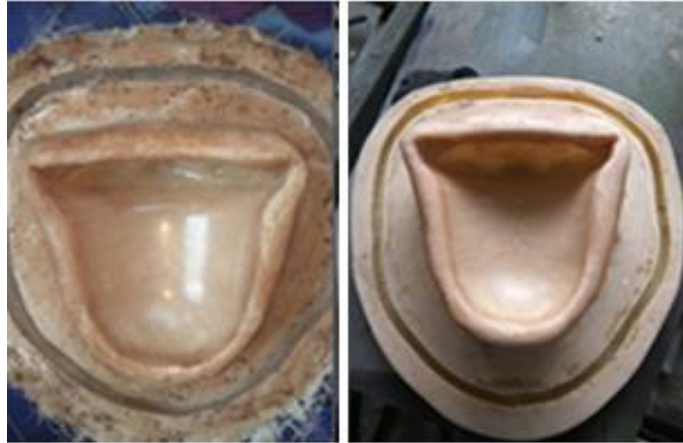
Gambar 3.31 Pelepasan Lis Pengunci
