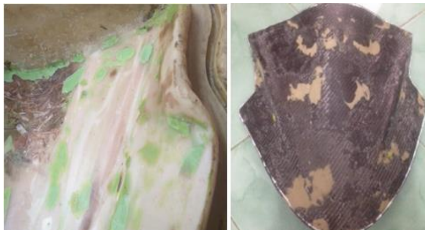
Gambar 2.3 Cacat Pada Permukaan Produk Komposit
