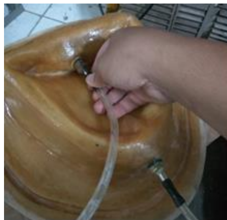
Gambar 3.44 Pemasangan Selang dan Menutup Cetakan
