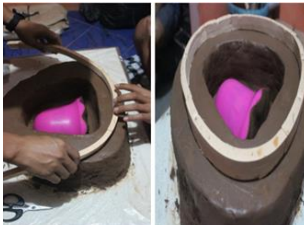
Gambar 3.22 Pembuatan Lis Pengunci
