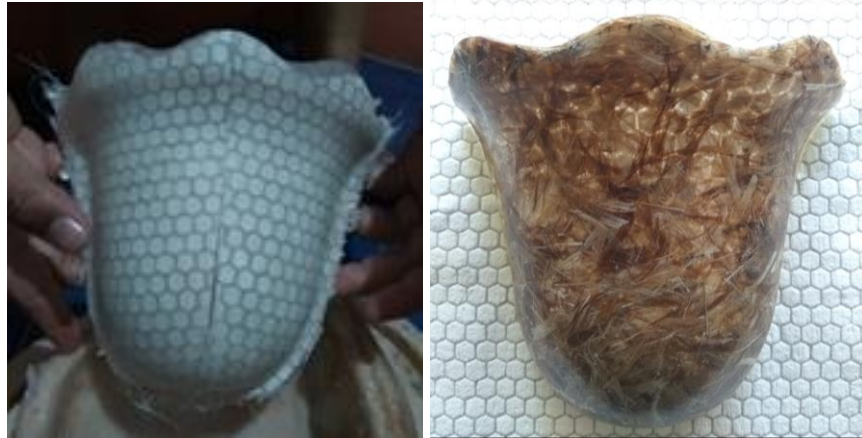
Gambar 3.39 Resin Berhasil Mengikat Serat (a) Fiberglass dan Lantor Soric (b) Fiberglass, Lantor Soric dan Bulu Ayam
