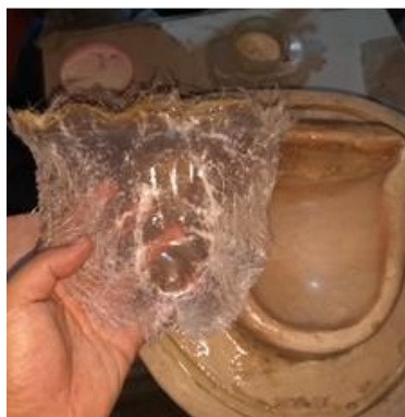
Gambar 3.38 Resin Telah Menyebar Dengan Baik
