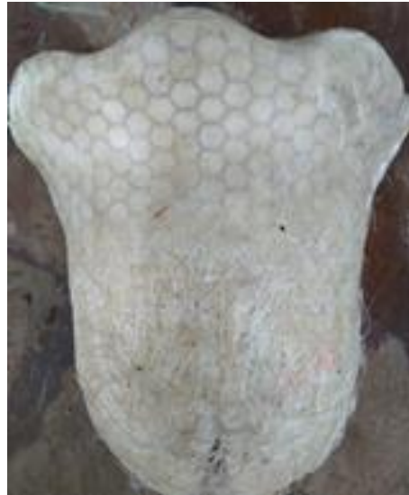
Gambar 4.8 Hasil Produk Komposit Sandwich Menggunakan 0,36% Katalis
