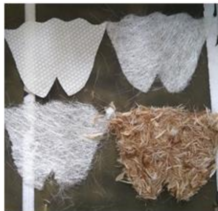
Gambar 3.40 Pemotongan Fiberglass, Lantor Soric dan Bulu Ayam
