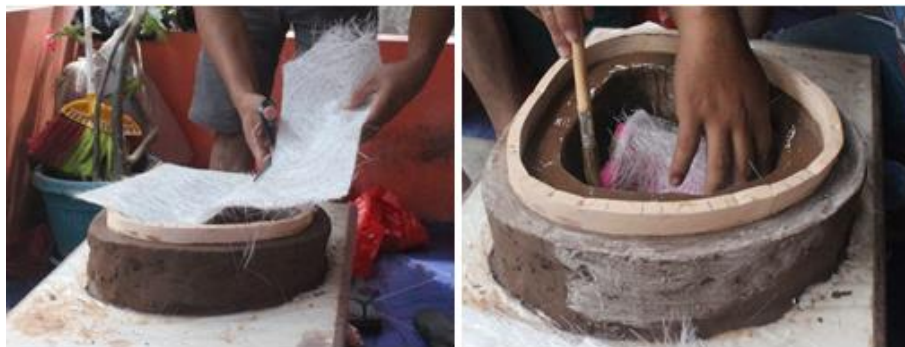
Gambar 3.26 Pemotongan dan Peletakan Fiberglass
