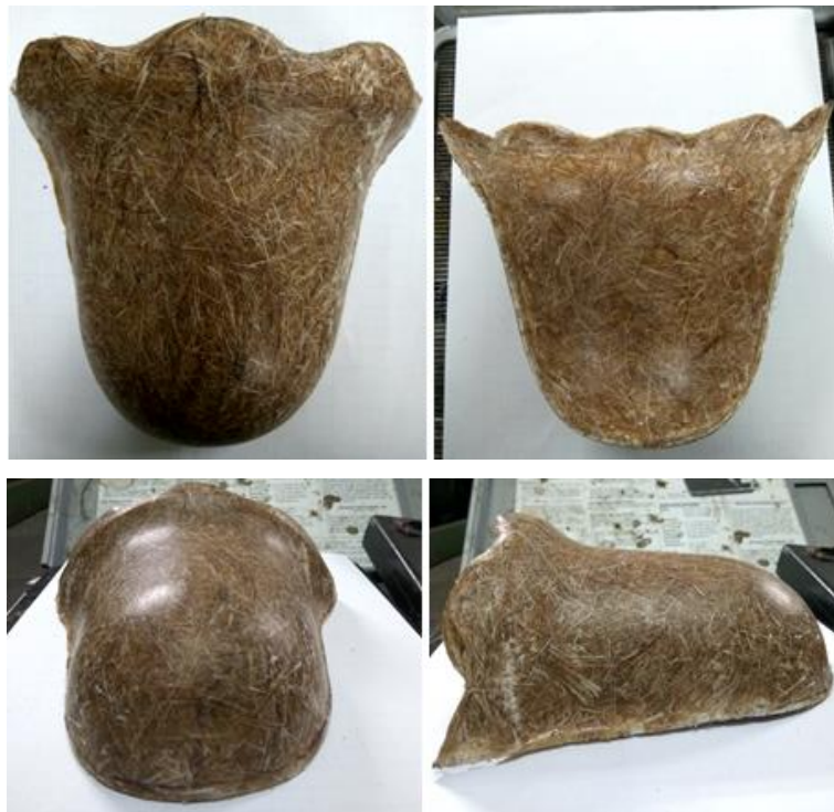
Gambar 4.11 Komposit Sandwich dengan Penggunaan 75% Serat Bulu Ayam
