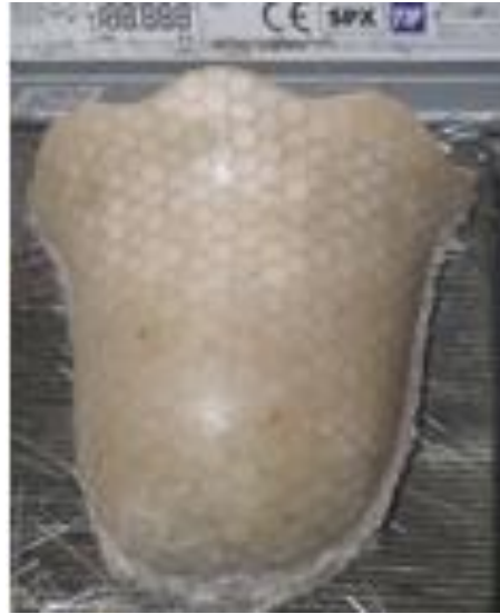
Gambar 4.7 Hasil Produk Komposit Sandwich Menggunakan 0,28% Katalis
