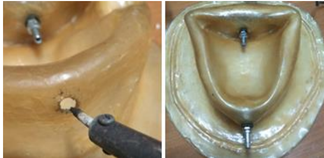
Gambar 3.37 Pembuatan Lubang dan Pemasangan Port Konektor
