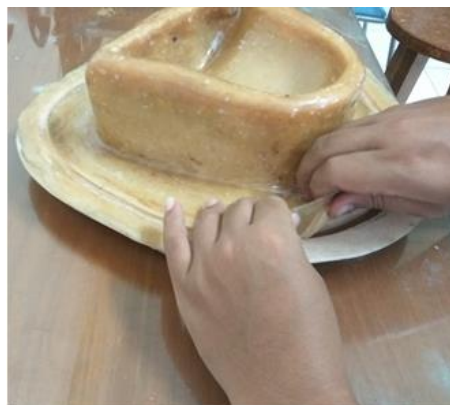
Gambar 3.36 Pelepasan Lateks dari Cetakan
