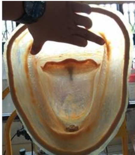
Gambar 4.5 Ketebalan Lateks Yang Tidak Merata
