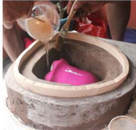
Gambar 3.25 Penuangan Resin Tahap I
