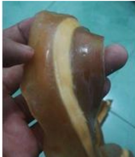
Gambar 4.4 Lis Pengunci Tidak Mengering
