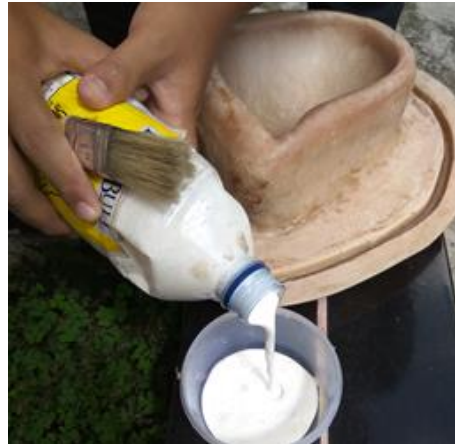
Gambar 3.33 Penyiapan Cairan Lateks
