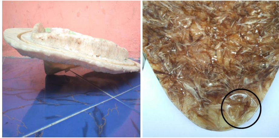
Gambar 2.2 (a) Cetakan Yang Belum Sempurna dan (b) Cacat yang Terjadi Akibat Bekas Konektor
