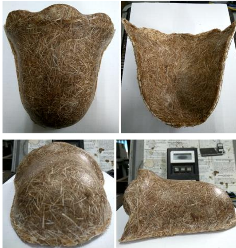
Gambar 4.12 Komposit Sandwich Dengan Penggunaan 100% Serat Bulu Ayam
