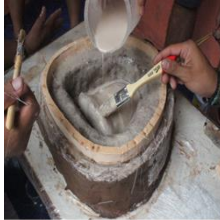
Gambar 3.27 Penuangan Resin Tahap II
