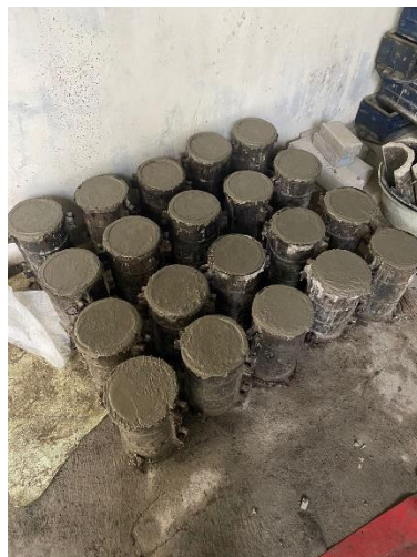
Gambar L. 8.6 Proses Pencetakan Beton
