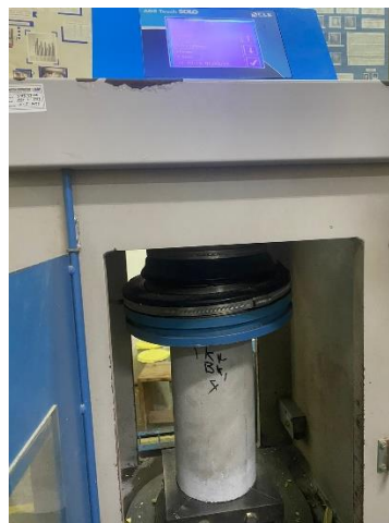
Gambar L. 8.9 Proses Uji Tekan Beton
