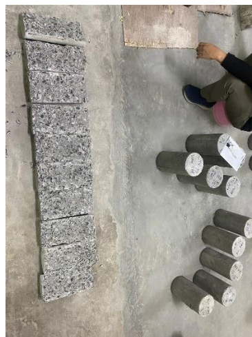
Gambar L. 8.12 Kondisi Setelah Uji Tarik Beton
