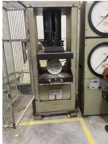
Gambar L. 8.11 Proses Uji Tarik Beton
