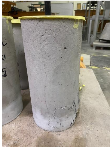
Gambar L. 8.10 Sampel Setelah Uji Tekan Beton
