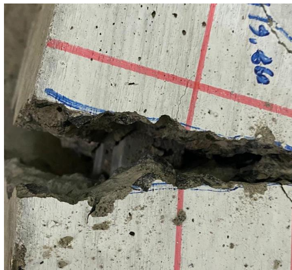
Gambar 5. 18 Detail tulangan pada balok BJ 02 – 2
