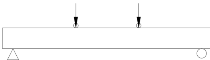
Gambar 3. 10 Model Pembebanan Balok Dengan Sistem Dua Titik
