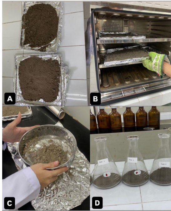
Gambar 3.7 Proses Pengeringan Sampel : (A) Sampel Sebelum di Oven, (B) Sampel di Oven, (C) Sampel di Ayak, dan (D) Sampel Kering di Erlenmeyer
