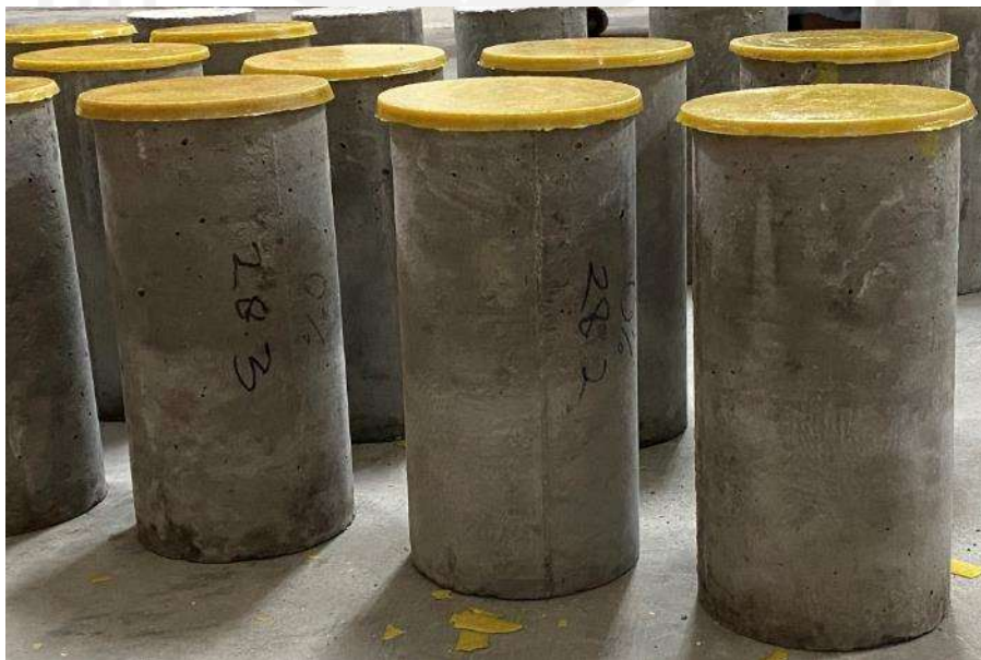
Gambar L-8.8 Silinder Beton yang Telah Dikaping
