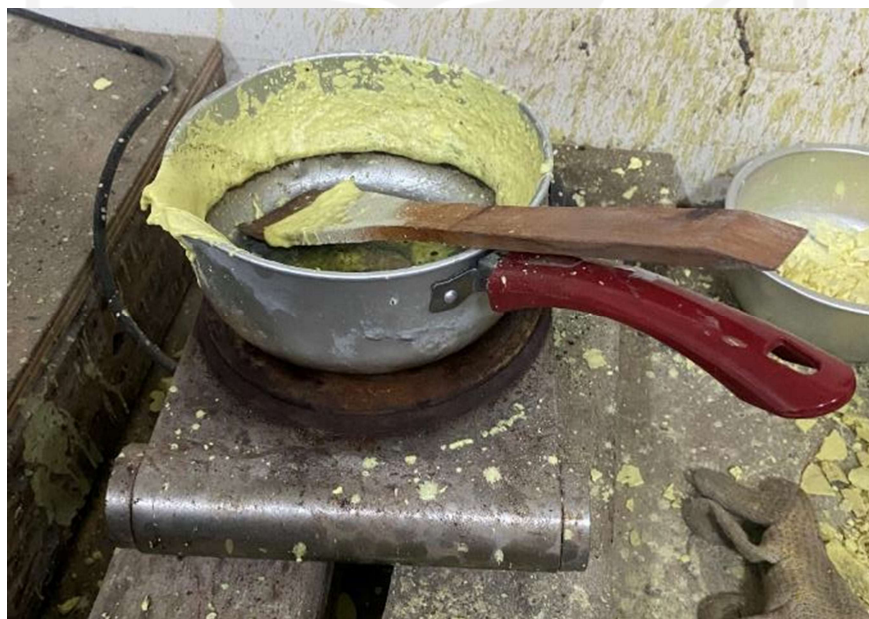
Gambar L-8.6 Pelelehan Belerang untuk Kaping
