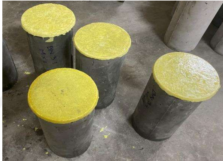
Gambar 4.12 Silinder Beton yang Telah Dikaping
