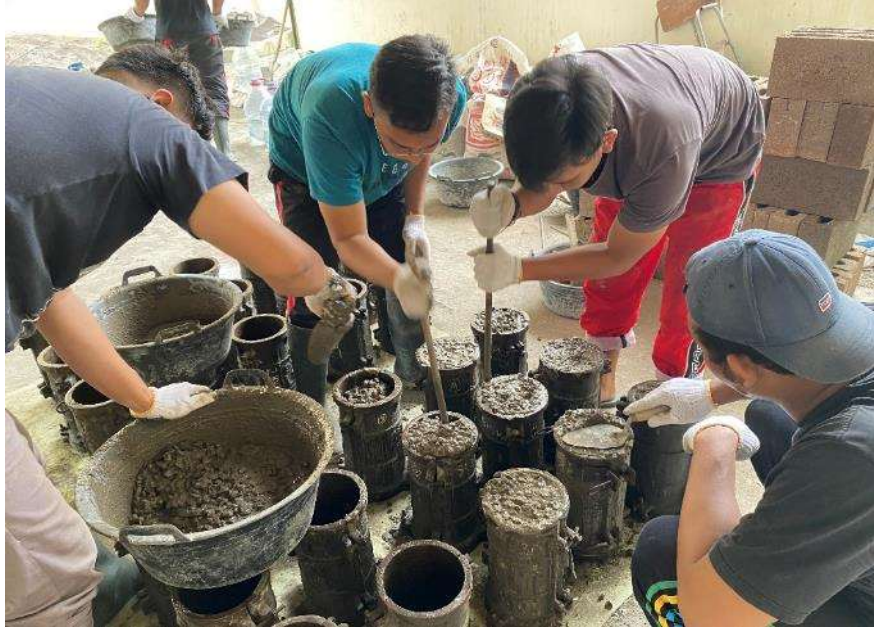
Gambar L-8.3 Pemadatan Campuran Beton pada Cetakan Silinder
