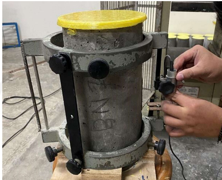
Gambar L-8.9 Pemasangan Dial Gauge
