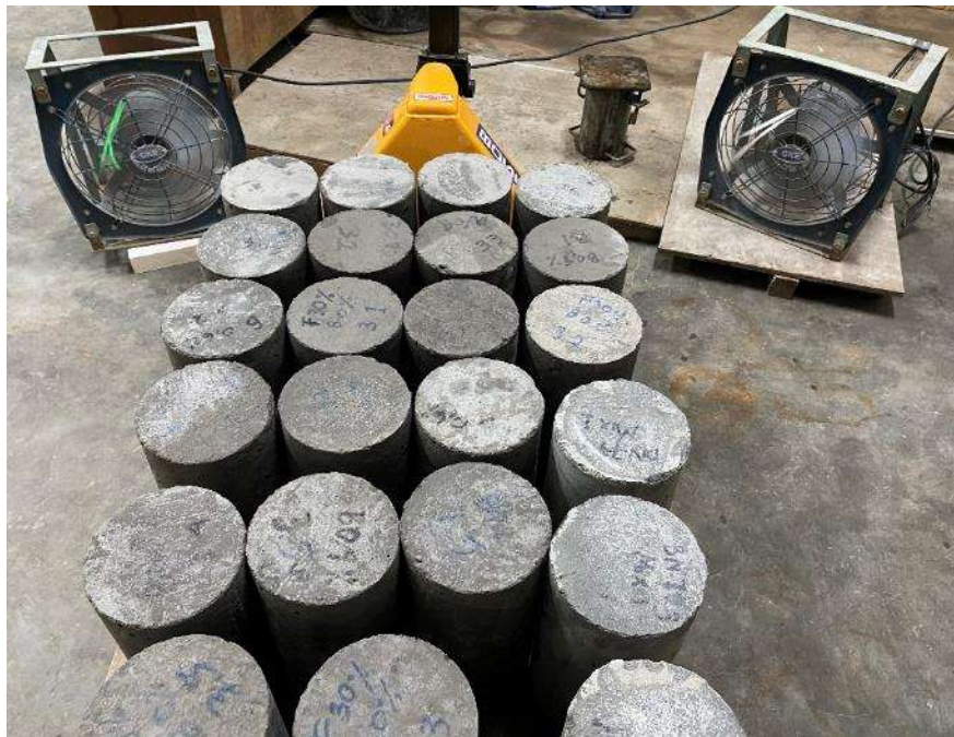
Gambar L-8.5 Pengeringan Silinder Beton Setelah Curing
