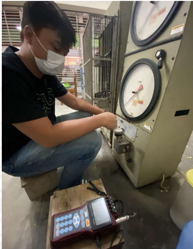
Gambar L-8.11 Pengujian Kuat Tekan dan Modulus Elastisitas Beton
