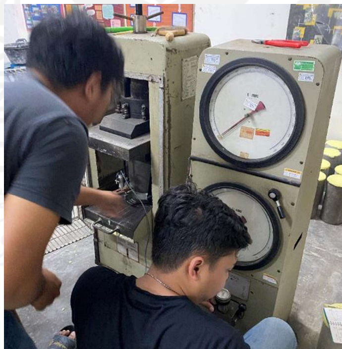
Gambar L-8.10 Persiapan Pengujian Kuat Tekan
