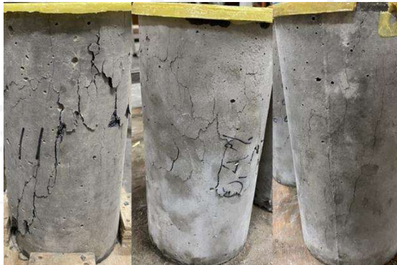
Gambar L-8.12 Pola Keretakan Benda Uji
